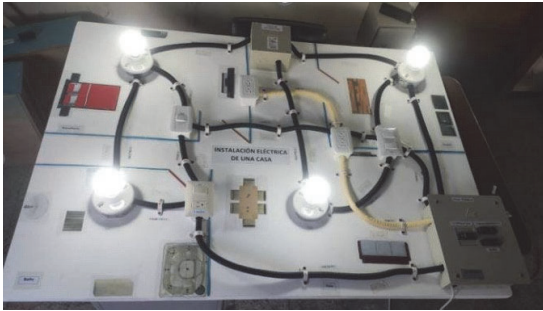
Figura 3. Maqueta didáctica con circuitos de iluminación y tomacorrientes
