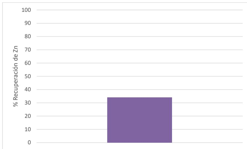
*Figura FT16* Recuperación de zinc proveniente de la lixiviación en hidróxido de sodio de polvos acería
