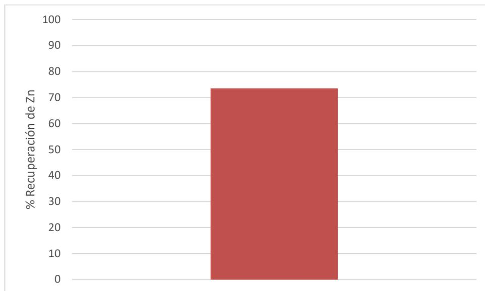
Figura FT14 Recuperación de zinc proveniente de la lixiviación en hidróxido de sodio de polvos acería
