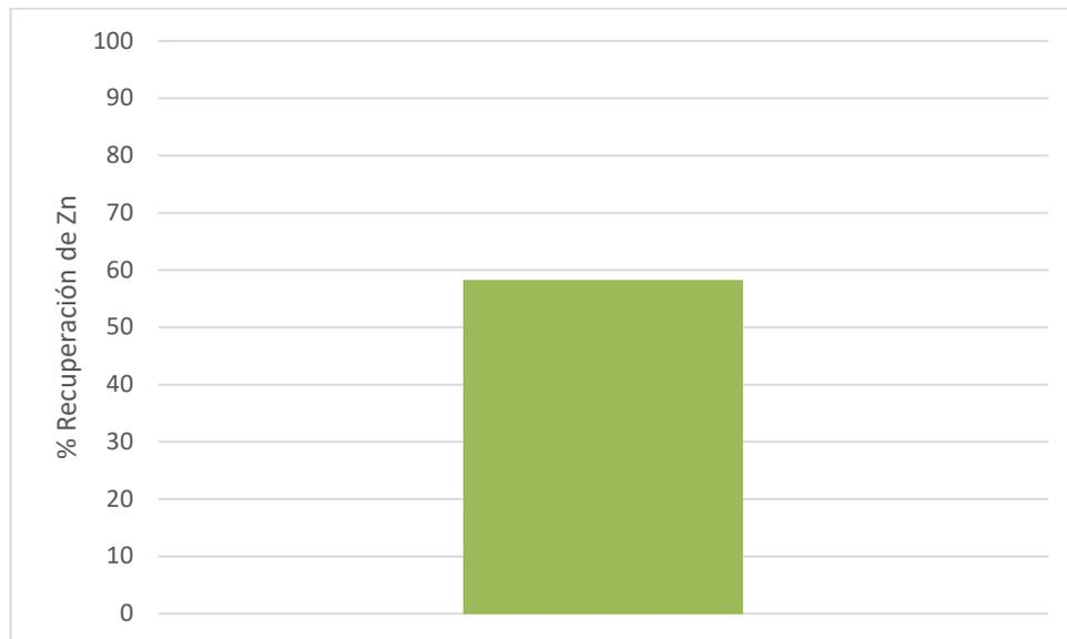
*Figura FT15* Recuperación de zinc proveniente de la lixiviación en hidróxido de sodio de polvos acería
