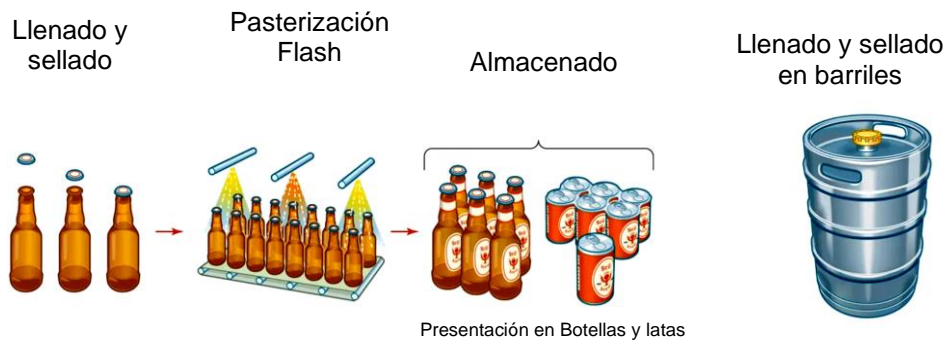
Figura 7. Esquema de procesos de Llenado, Envasado de cerveza
