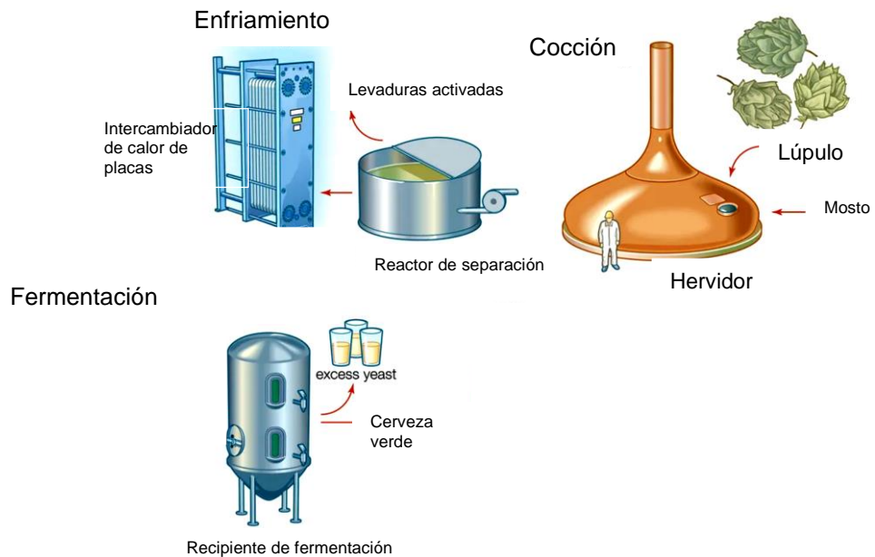
Figura 5. Esquema cocción y Fermentación
