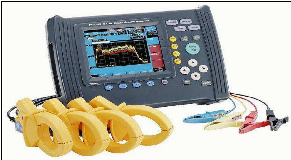
Figura 4.14 Analizador de energía Hioki 3196.
