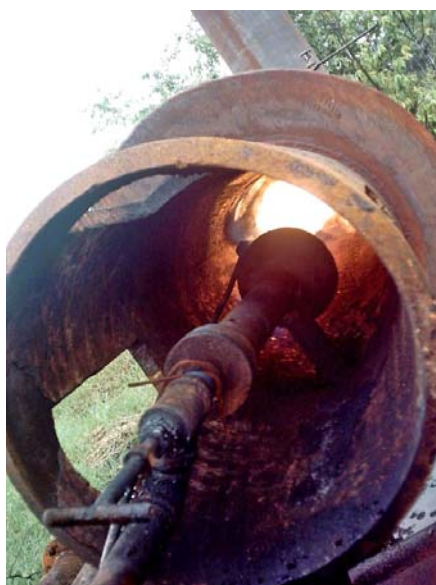
Figura N° 1.15. Lado del calentador donde se presenta el gradiente de temperatura más elevado
