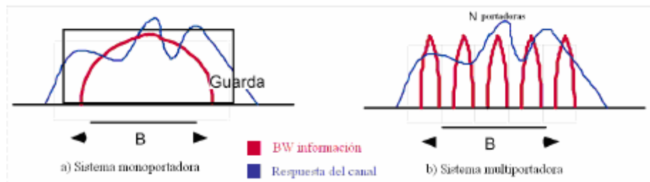
Figura 2.3: Sistema monoportadora vs. Multiportadora
