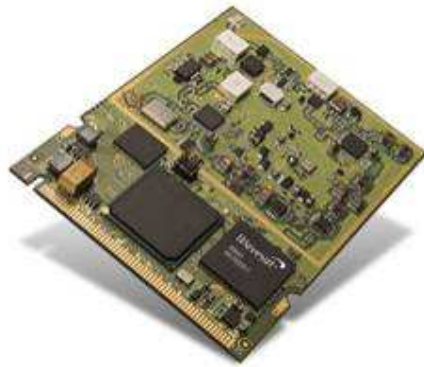
Figura 4.14: Emulador de estación base.
