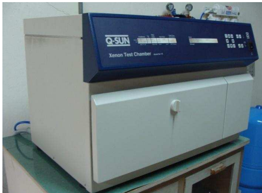
Figura 2.12. Cámara de Arco de Xenón
