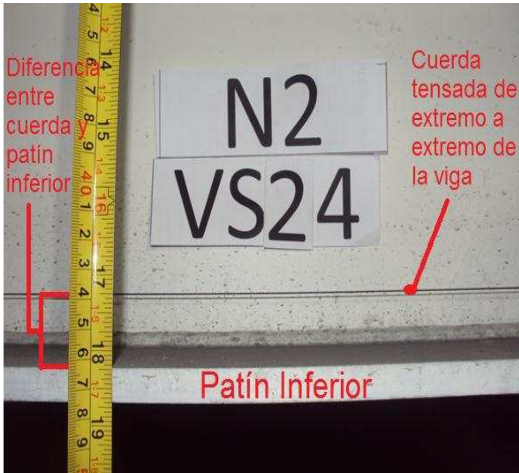
Figura 4.50. Procedimiento para medir la deflexión de una viga.
