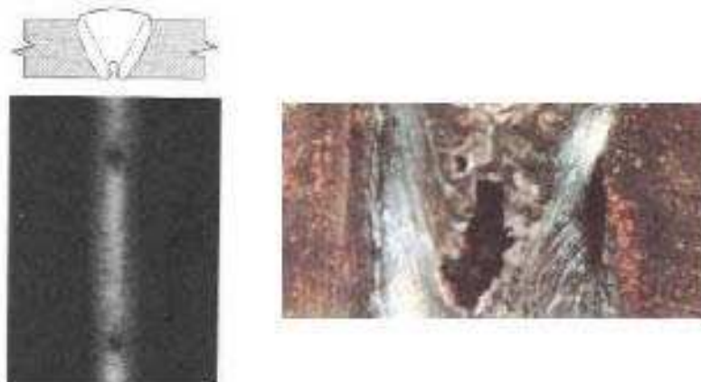
Figura 2.28. Defecto de quemado en soldadura.
