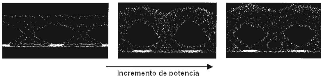
FIGURA 3.6 Distorsión del diagrama del ojo a causa de la SPM
