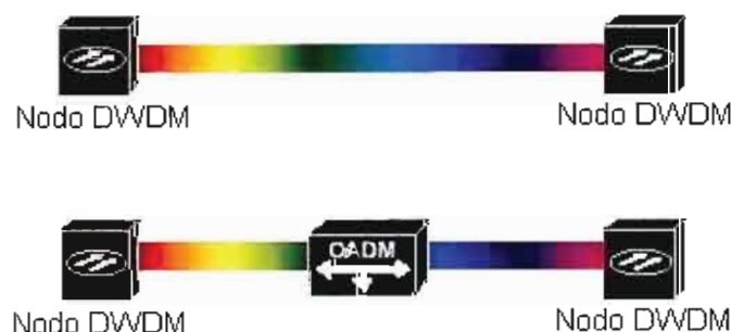
FIGURA 1.34 Topología DWDM punto a punto
