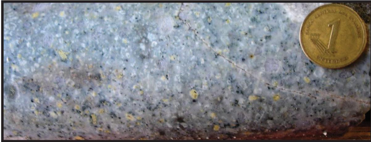
**Fotografía 8. MJJ15-50.30m. Pórfido dacítico de cuarzo-feldespato con alteración propilítica (plagioclasas cloritizadas y epidotizadas-Epi) y overprinting cuarzo-sericita. Diámetro de la moneda 1.8 cm.**
