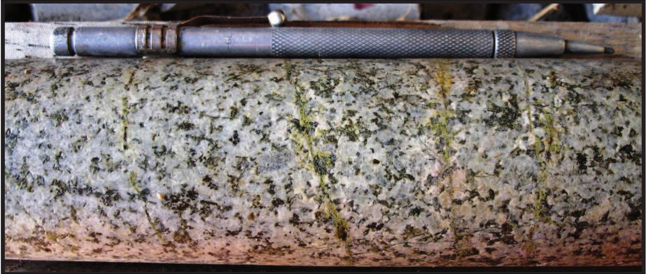
**Fotografía 6. MJJ1-53m. Vetillas de epidota que cortan a la granodiorita de la caja con alteración propilítica.**
