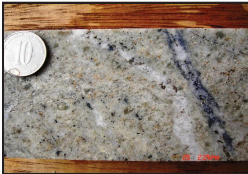
**Fotografía 3. MJJ29-532.95m. Roca con alteración cuarzo, sericita +/-clorita. Vetilla irregular de cuarzo con bornita (tipo A) junto a vetilla sub-paralela tipo B con línea central y molibdenita en los bordes de la misma. Diámetro de la moneda 1.7 cm.**
