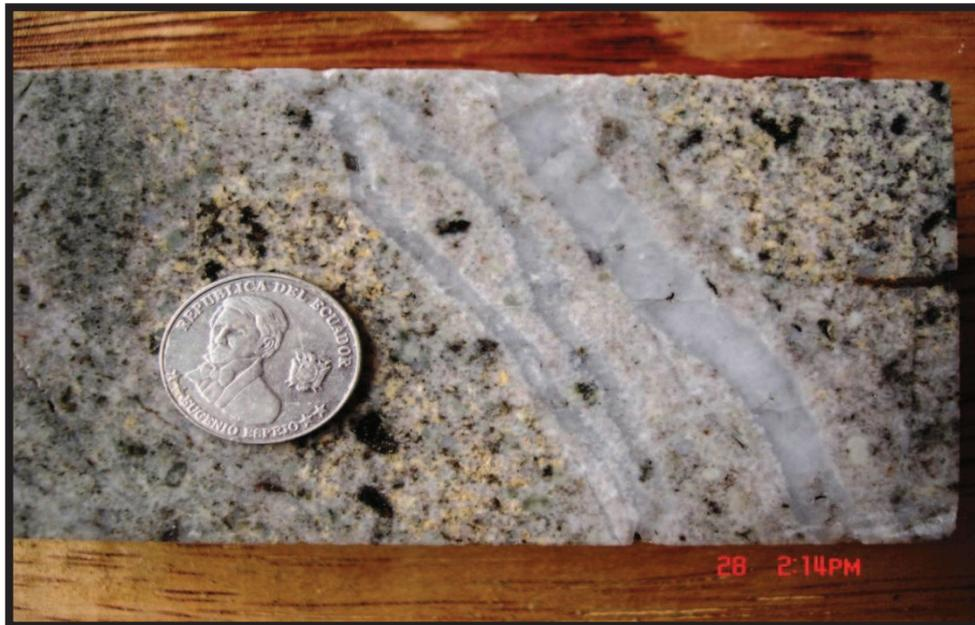
**Fotografía 7. MJJ29-5502mm. Granodiorita de biotita con alteración potásica cortada por vetillas irregulares de cuarzo tipo A. Los minerales máficos (m) están preservados en los halos de alteración cuarzo-sericita-ortoclasa. Diámetro de la moneda 1.7 cm.**
