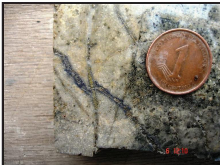
**Fotografía 5. MJJ29-353.9m. Vetilla de cuarzo-calcopirita-pirita (tipo D) con halo de alteración cuarzo-sericita. Corta y desplaza a vetilla de cuarzo-molibdenita (tipo B). Diámetro de la moneda 1.8 cm.**
