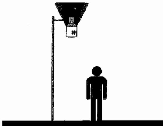
Fig. 6.14.b Luminaria que produce mucha contaminación luminosa
