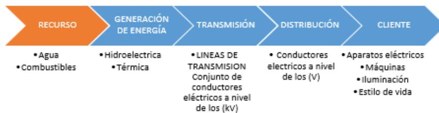
Figura 1: Esquema del Sistema Eléctrico Tradicional del siglo XIX y XX
