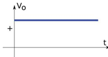
Figura 5: Señal de Voltaje Continuo
