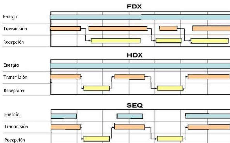
Figura 1.7: Esquema de los 3 procesos de la comunicación entre el lector y las etiquetas [6]
