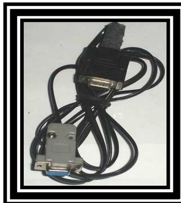
Figura 3.7: Cable con conector DB9 hembra a DB9 hembra
