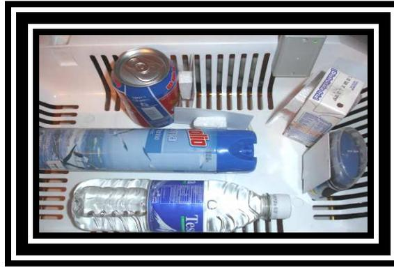
Figura 4.4: Prueba con productos de difícil lectura (productos metálicos con aislante)
