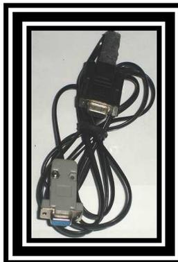
Figura 3.22: Cable con conector hembra-hembra
