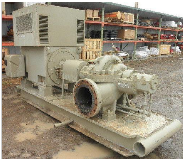
Figura 2. 22 Placa base con tubos con de izaje
