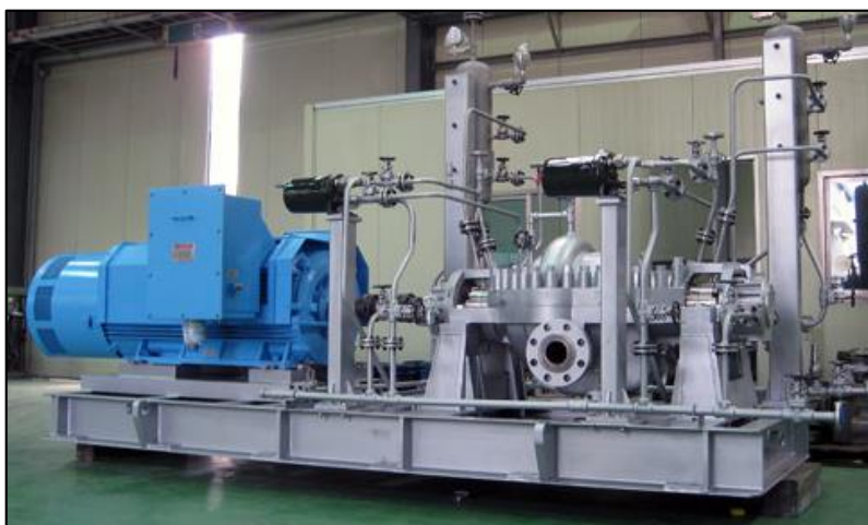
Figura 2. 23 Placa base con cuatro orejas de izaje a los costados de las vigas principales
