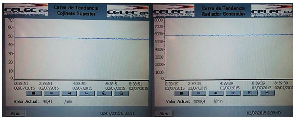
Figura 3.7. Curvas de tendencia Cojinete Superior y Generador
