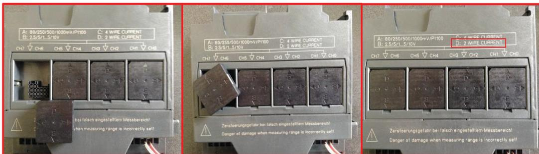
**Figura 2.5.** Configuración del módulo para transmisores de corriente de dos hilos
