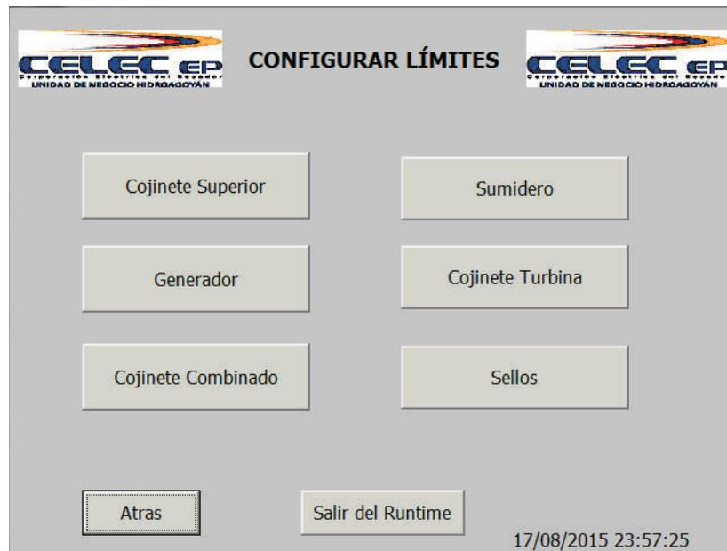
**Figura B.7.** Pantalla Configuración de Límites
