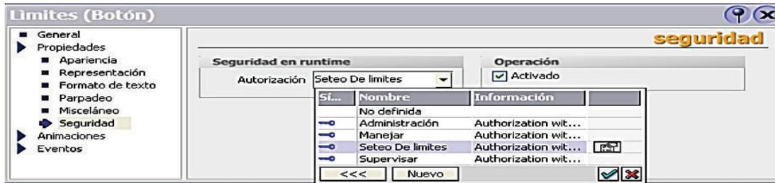
Figura 2.30. Configuración de la propiedad de seguridad del botón “Límites”
