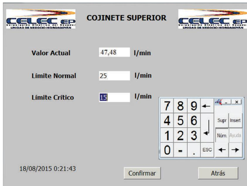
**Figura B.8.** Configuración de Límites del Cojinete Superior
