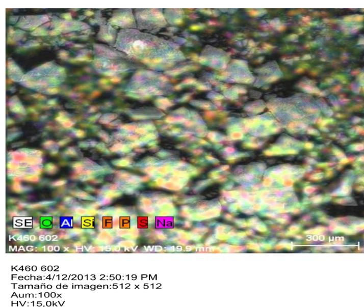
**Figura AI. 6.** Observaciones al microscopio electrónico de barrido de una muestra de lodo anódico
