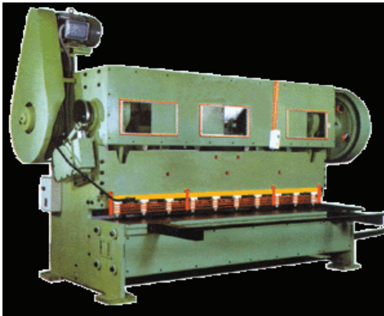
Figura 1.2 Corte Mediante Cizalla Industrial.
