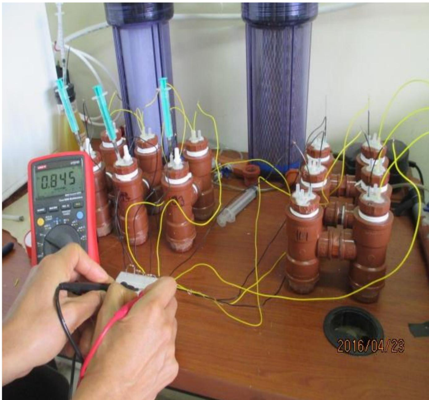
**FIGURA 3.7** Medición de diferencia de potencial de la PCM
