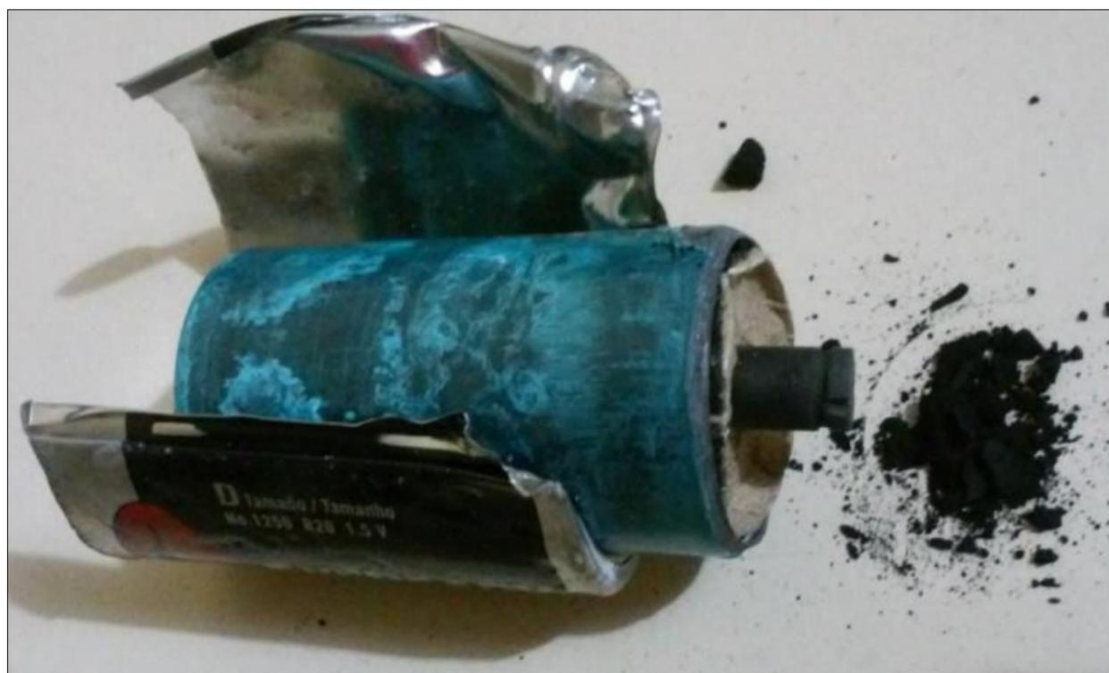
**FIGURA 3.1** Pila de zinc – carbono con su electrodo
