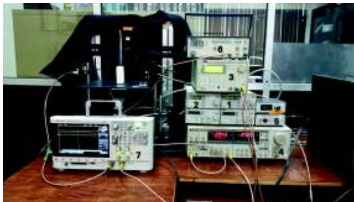
Figura 3.4: Equipo GASMAS del departamento de Física de la EPN. Equipo electrónico: 1. Control de corriente, 2. Control de temperatura, 3. Generador de modulación, 4. Amplificador Lock-in, 5. Fuente de alto voltaje del tubo foto multiplicador, 6. Generador de Funciones, 7. Osciloscopio, 8. Diodo láser.
