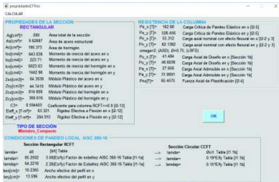
FIGURA 61 RESULTADOS COLUMNA 100X200X2 CON ATIESADOR
