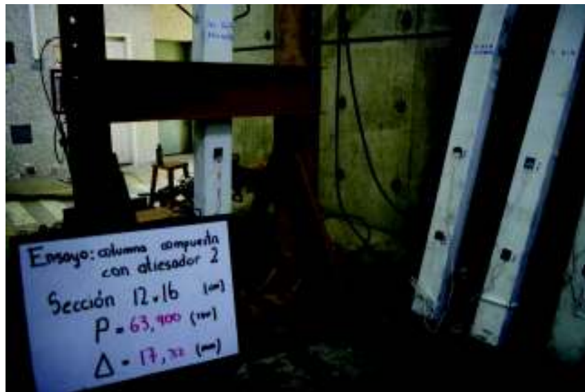
FIGURA 99 ENSAYO COLUMNA COMPUESTA 120X160 CON ATIESADORES 2
