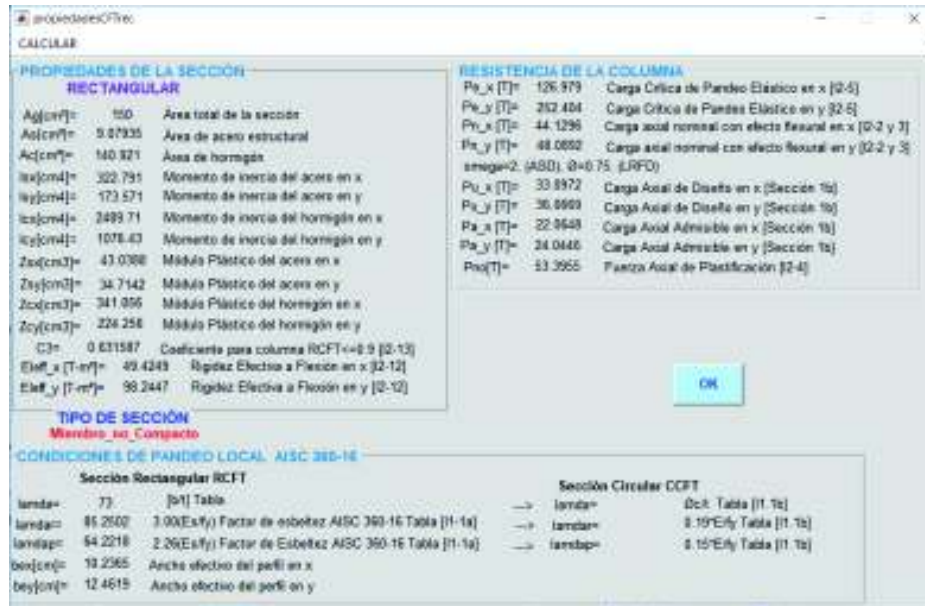
FIGURA 60 RESULTADOS COLUMNA 100X150X2 SIN ATIESADOR
