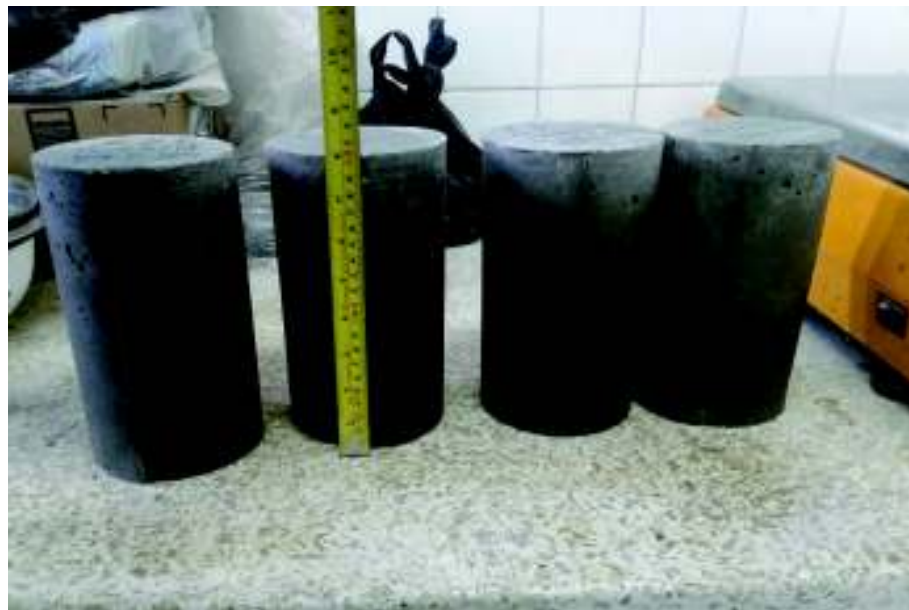
FIGURA 18 DIMENSIONAMIENTO DE LAS PROBETAS DE HORMIGÓN
