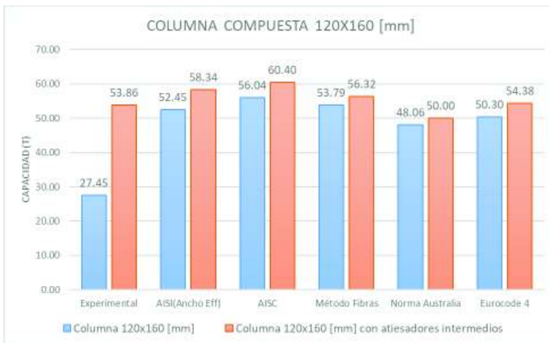
FIGURA 145 COMPARACIÓN CAPACIDAD A COMPRESIÓN COLUMNA COMPUESTA 120X160 [mm]
