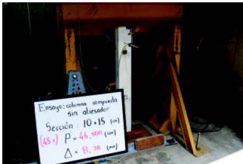
FIGURA 104 ENSAYO COLUMNA COMPUESTA 100X150 SIN ATIESADORES
