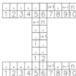
FIGURA 53 DISCRETIZACIÓN DEL PERFIL “I” DE ACERO ESTRUCTURAL.
