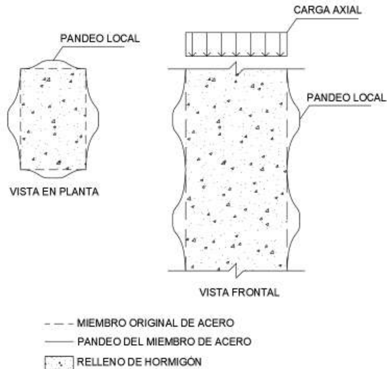
FIGURA 6 ESQUEMA DE PANDEO LOCAL EN PLACAS
