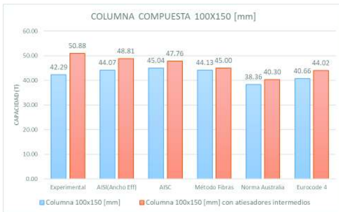
FIGURA 147 COMPARACIÓN CAPACIDAD A COMPRESIÓN COLUMNA COMPUESTA 100X150 [mm]
