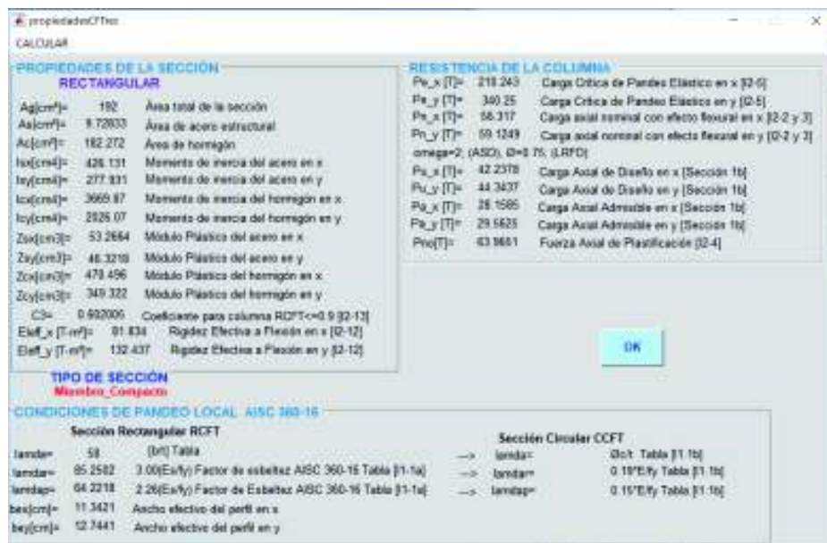
FIGURA 62 RESULTADOS COLUMNA 120X160X2 CON ATIESADOR
