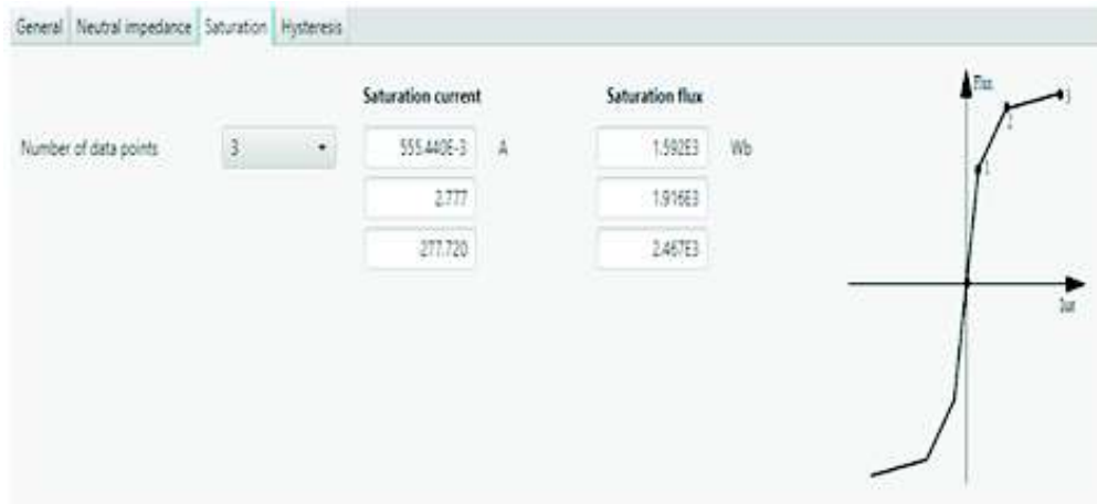
Figura 3.6 - Parámetros de la curva de saturación
