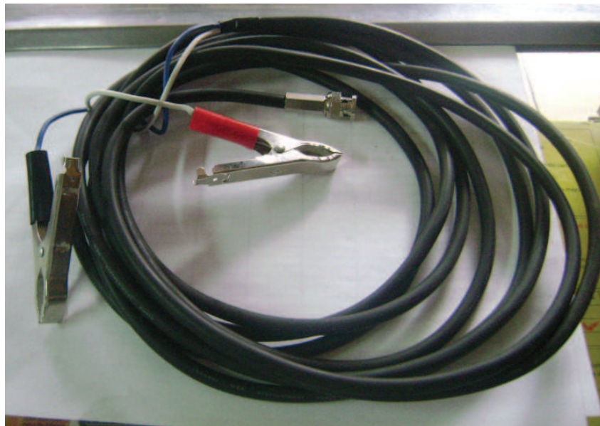
Figura A.12 Cable Señal Voltaje Batería.
