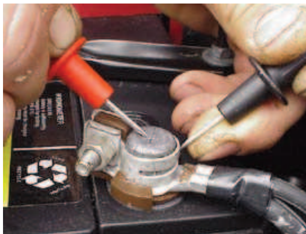
Figura 1.8 Prueba de resistencia eléctrica de los bornes, tomada de [5]
