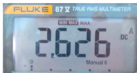
Figura 4.2. Valor de la corriente generada por el alternador.
