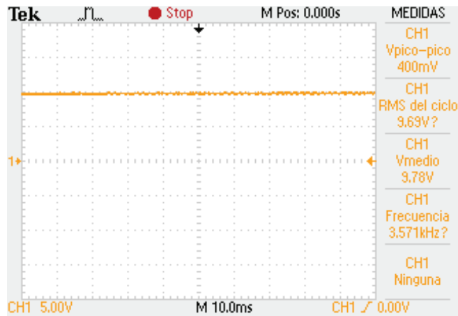
Figura 4.3. Voltaje generado por el regulador hacia el alternador.
