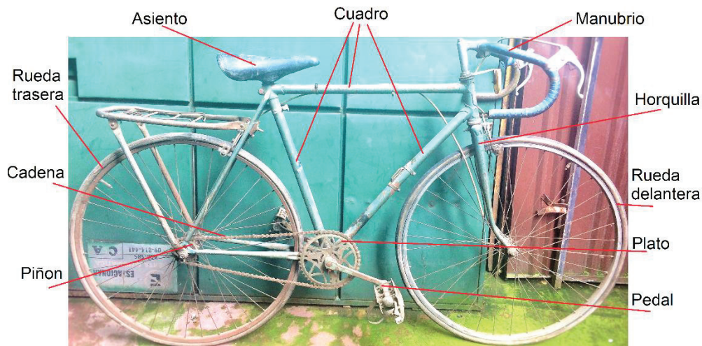
Figura 2.1. Bicicleta convencional utilizada y sus partes.
