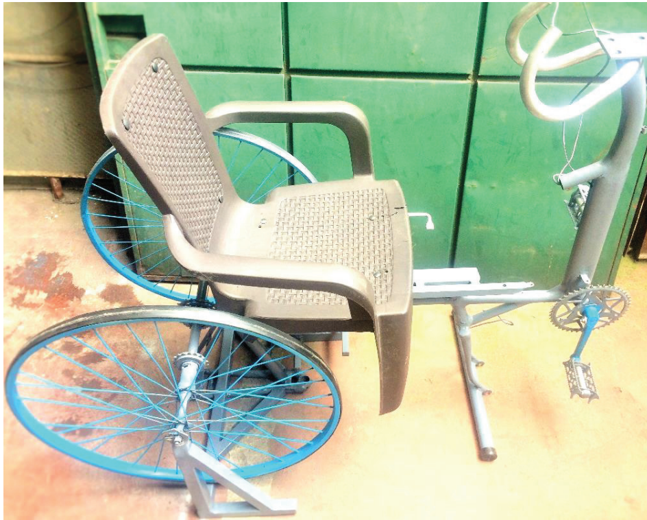
Figura 2.13. Estructura final del prototipo, incluido asiento y agarradera.
