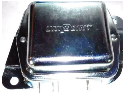
Figura 2.15. Regulador automotriz externo utilizado en el proyecto.
