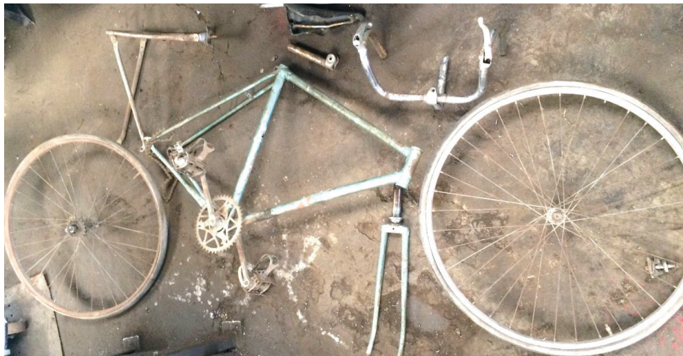
Figura 2.9. Bicicleta convencional despiezada.
