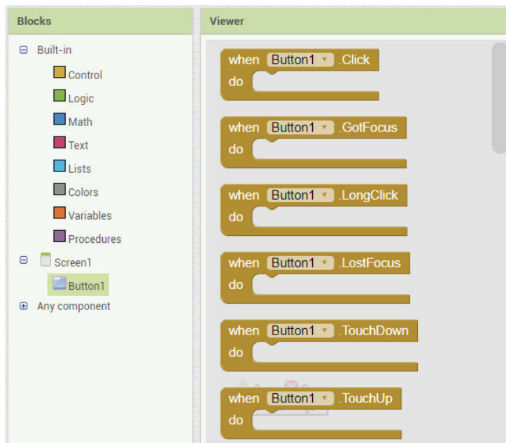
Figura 3.13. Bloques de programación de un pulsador, MIT App Inventor.
