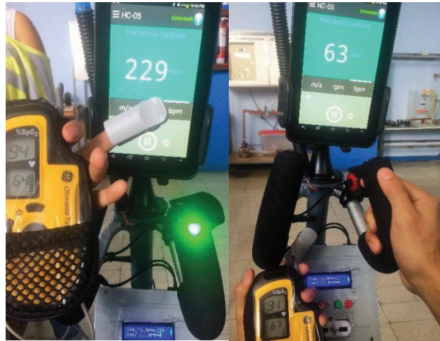
Figura 4.8. Sensado de la frecuencia cardiaca, antes y después de colocar el dedo pulgar en el sensor.
