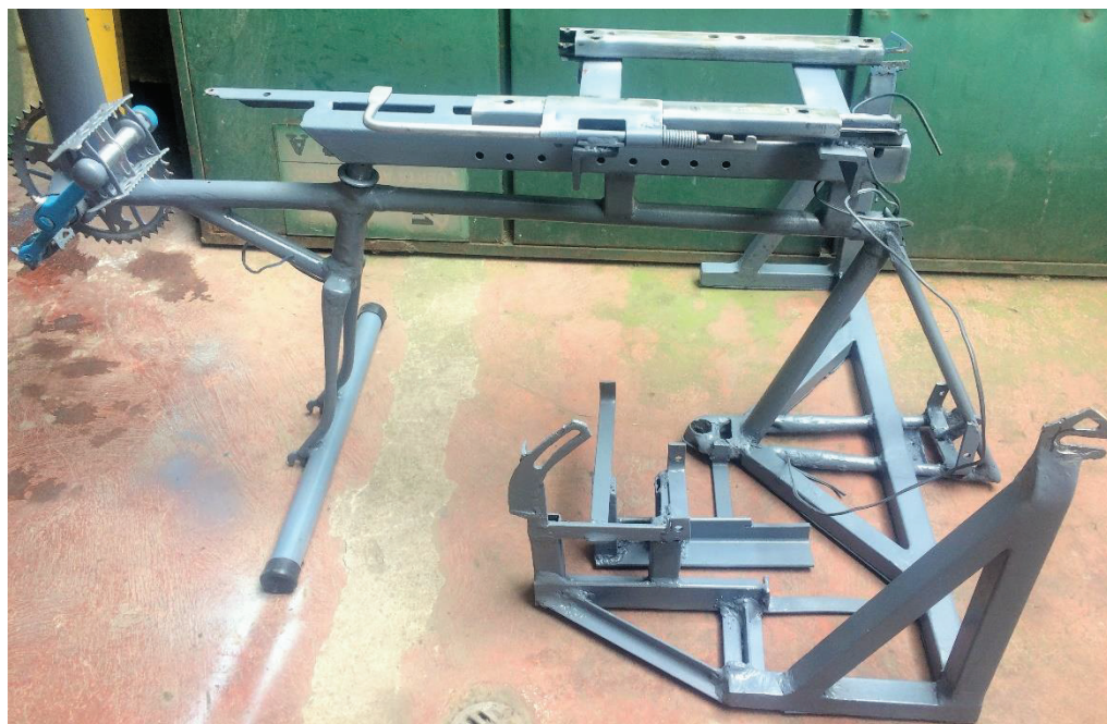
Figura 2.12. Estructura del prototipo con rieles para el asiento, y soporte para el alternador.
