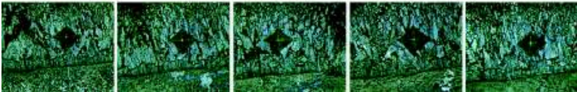
Ensayo de micro-indentación de la probeta A3-M1 (400x)
