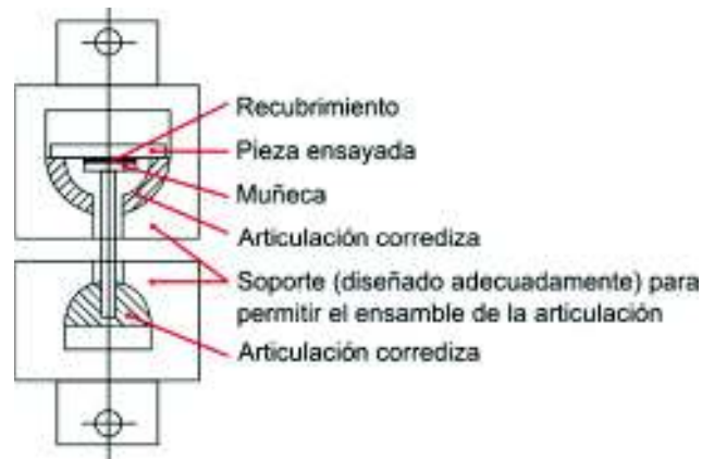
Figura 1.13. Ensamble para el ensayo de Pull-Off de sustratos rígidos, usando una sola muñeca. (Fuente: ISO, 2016)
