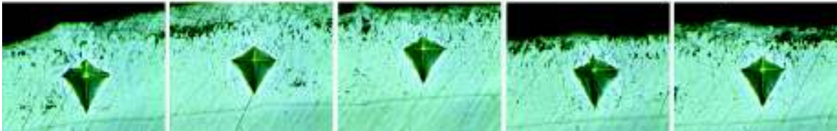
Ensayo de micro-indentación de la probeta B3-M1 (400x)
