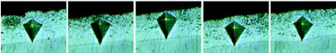
Ensayo de micro-indentación de la probeta B2-M1 (400x)
