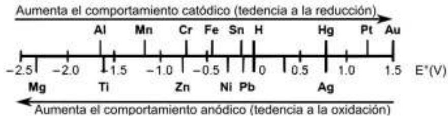
Figura 1.1. Potenciales eléctricos de metales en una solución acuosa con cloruro de sodio a 20°C. (Fuente: Kuklik & Kudlacek, 2016)
