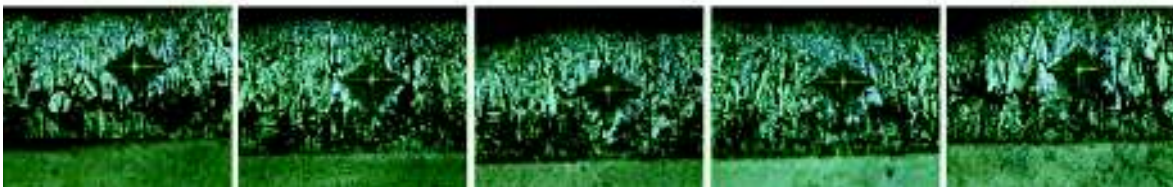
Ensayo de micro-indentación de la probeta A1-M1 (400x)
