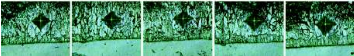
Ensayo de micro-indentación de la probeta A2-M1 (400x)
