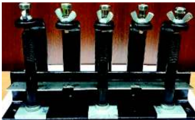
Figura 2.6. Dispositivo de unión probeta-muñeca. (Fuente: Propia)
