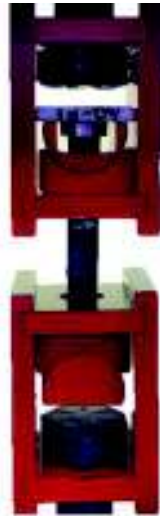
Figura 2.7. Dispositivo de Pull-Off para la máquina universal de ensayos. (Fuente: Propia)
