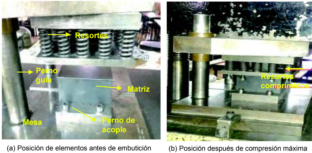
Figura 14. Posición inicial y final de elementos del utillaje de embutición Fuente: Propia
