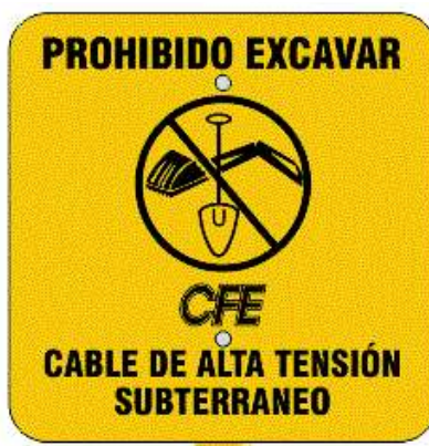
Figura 3.25. Señalización vertical de advertencia de cable de alto voltaje subterráneo
