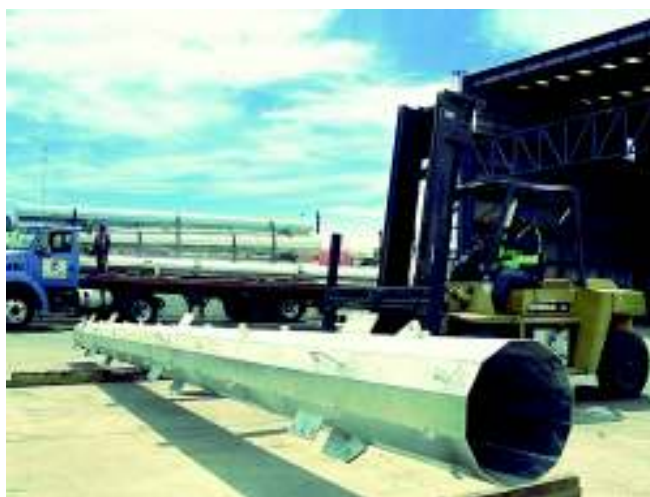
Figura 3.34. Poste metálico de 69 kV tipo troncocónico [34].
