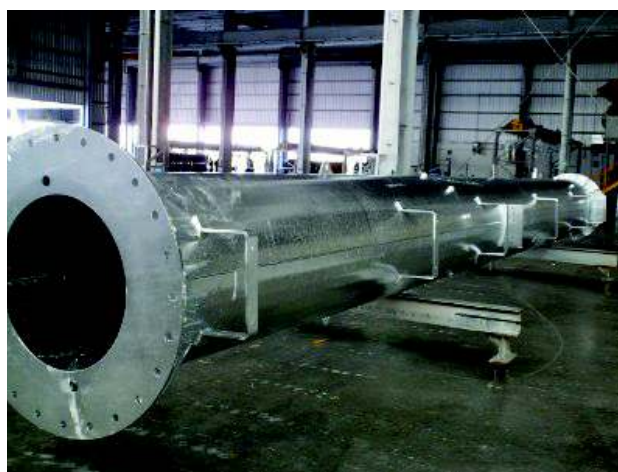
Figura 3.33. Poste de 69 kV tipo troncocónico [33].
