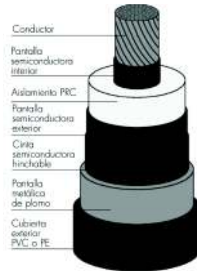
Figura 3.18. Partes constitutivas del cable de 69 kV XLPE de 240 mm 2 [16]
