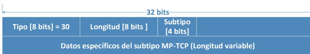
**Figura 1.5** Esquema general de los subtipos de mensajes MP-TCP
