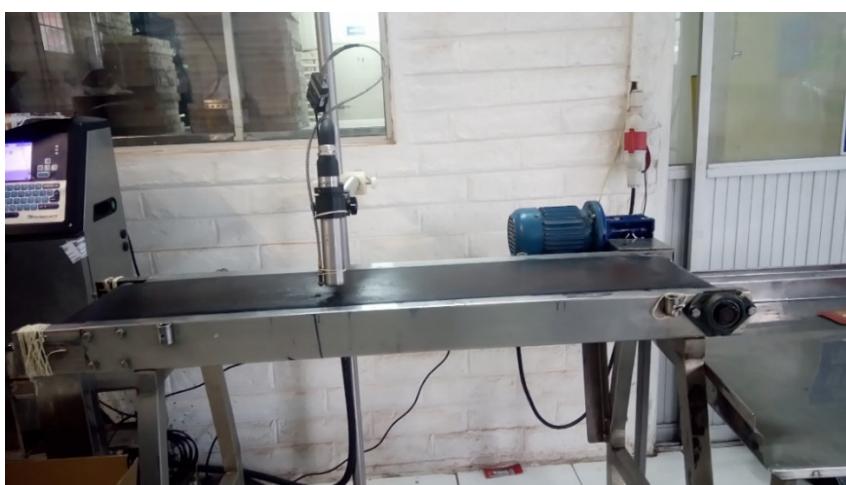
Figura 38 – Impresora para cajas de cartón Fuente: Propia de la investigación
