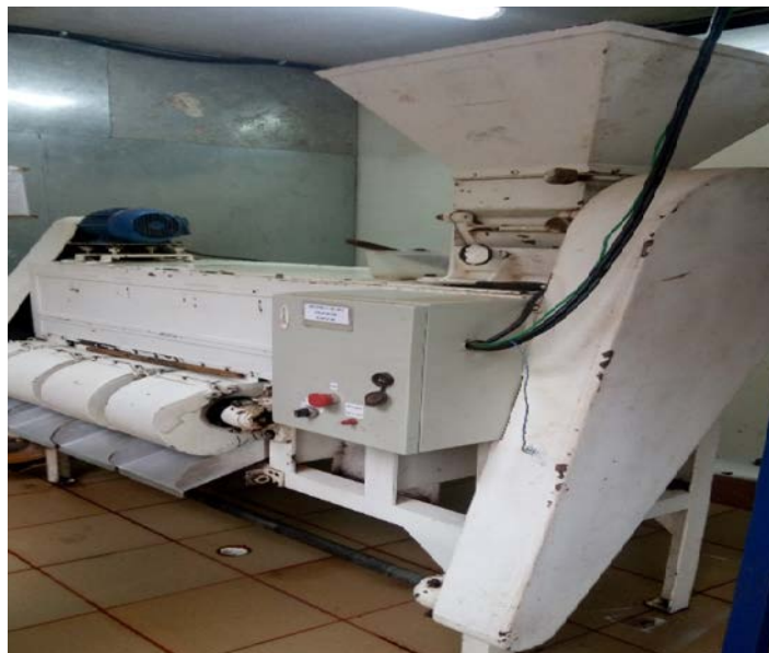
Figura 28 – Piladora de cacao Fuente: Propia de la investigación
