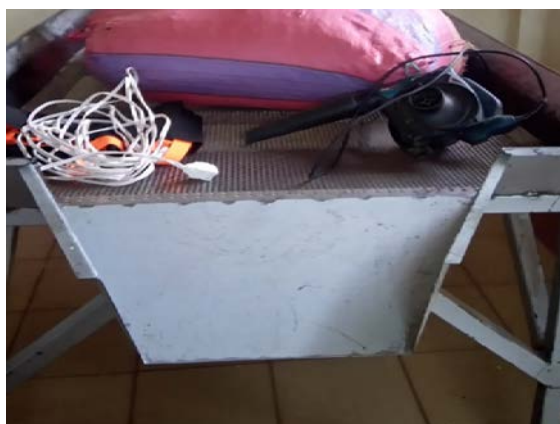
Figura 24 – Tol para clasificar las pepas de cacao Fuente: Propia de la investigación
