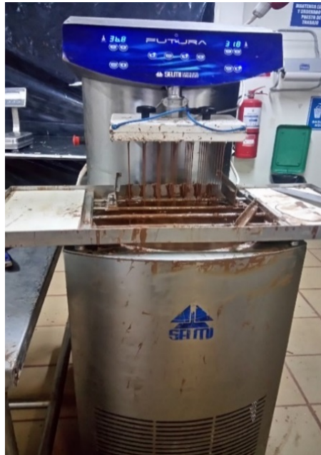
Figura 33 – Atemperadora Fuente: Propia de la investigación
