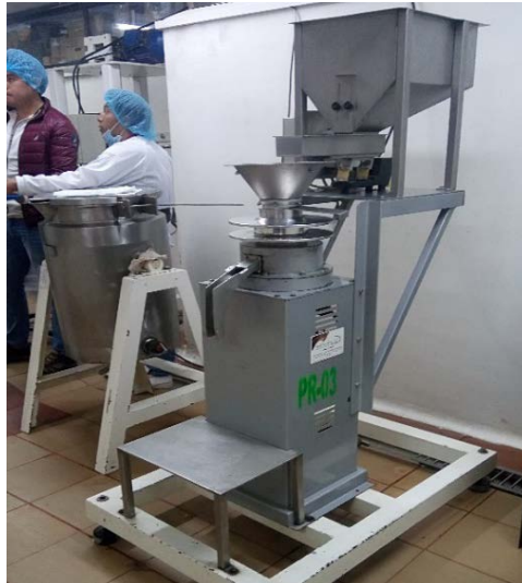
Figura 29 – Pre-molino Fuente: Propia de la investigación
