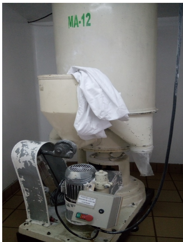
Figura 35 – Refinadora de azúcar Fuente: Propia de la investigación
