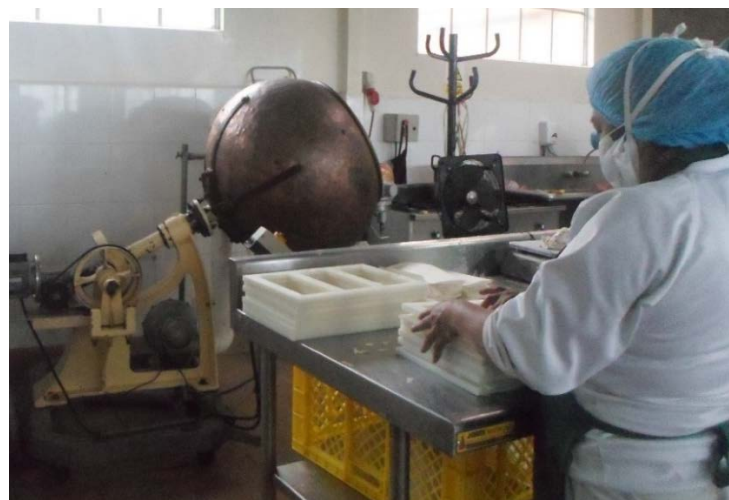
Figura 34 – Máquina grageadora Fuente: Propia de la investigación
