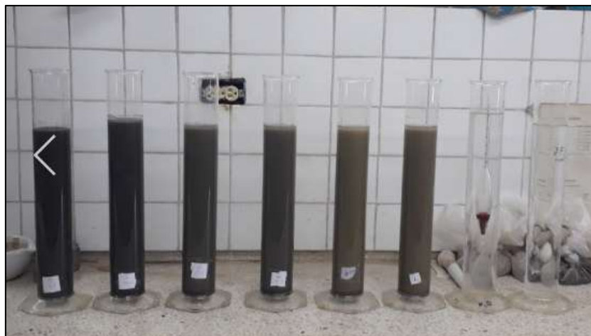
Figura 4.24. Ensayo Granulometría por Hidrómetro
