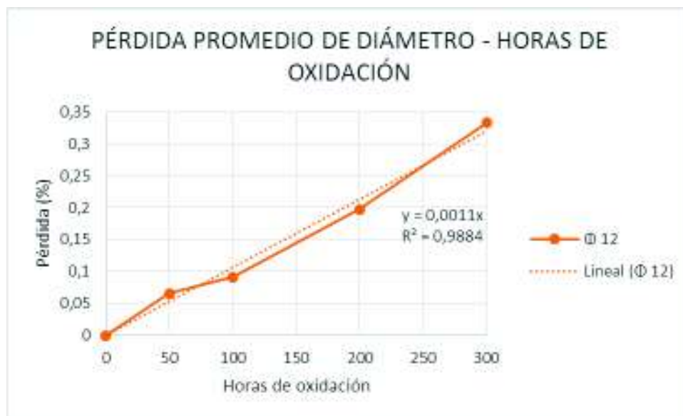
FIGURA 3.41 DIAGRAMA DE PÉRDIDA DE DIÁMETRO PORCENTUAL VS HORAS DE OXIDACIÓN PARA DIÁMETRO 12 MILÍMETROS
