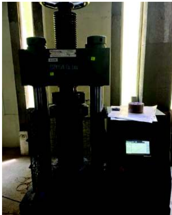
FOTO 3.17 EJECUCIÓN DE ENSAYO A COMPRESIÓN
