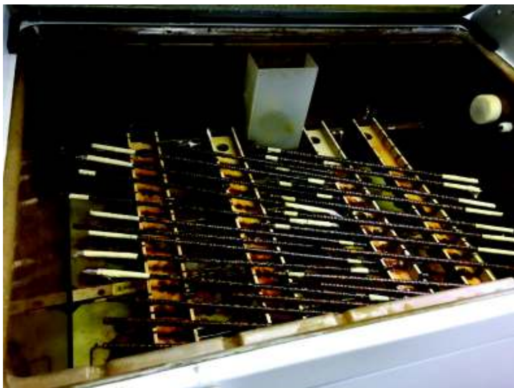
FOTO 3.9 EN CÁMARA SALINA OXIDACIÓN ACELERADA DE LAS VARILLAS A 50 HORAS
