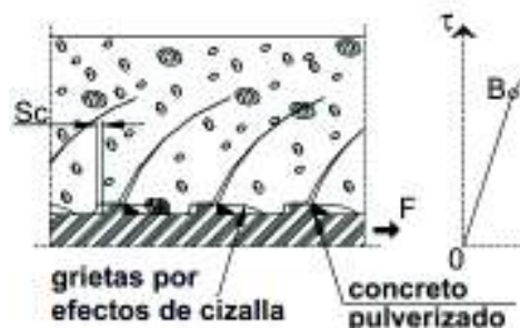
FIGURA 2.8 APARICIÓN DE FISURAS POR CORTANTE Y PROLONGACIÓN DE FISURAS RADIALES, DOMÍNGUEZ (2013).
