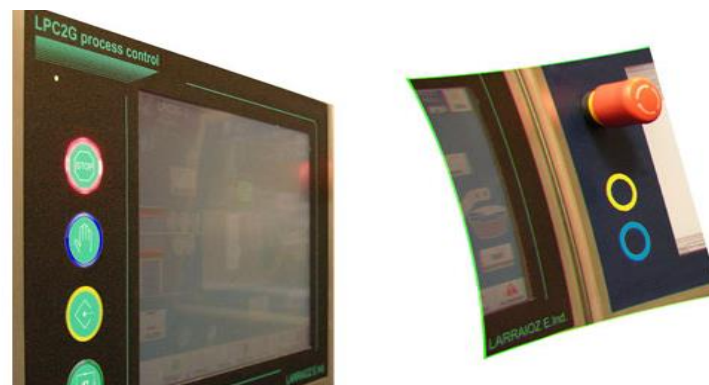
Figura 1.10 Panel táctil comercial en el que se usa conjuntamente botones de emergencia, marcha y paro [20].
