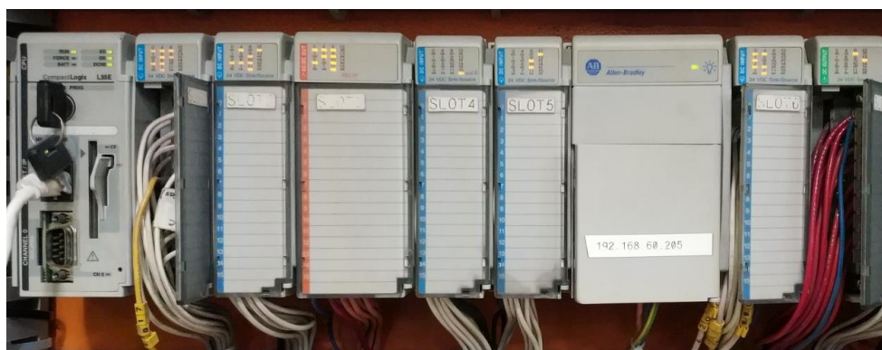
Figura 2.1 PLC CompactLogix L35E utilizado en la Máquina.
