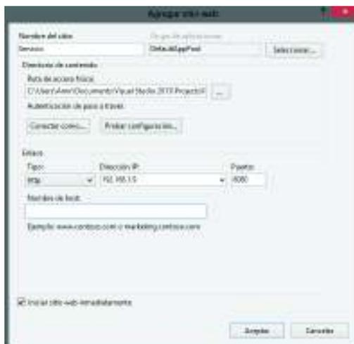
**Figura 2.24.** Configuración de un sitio web en IIS
