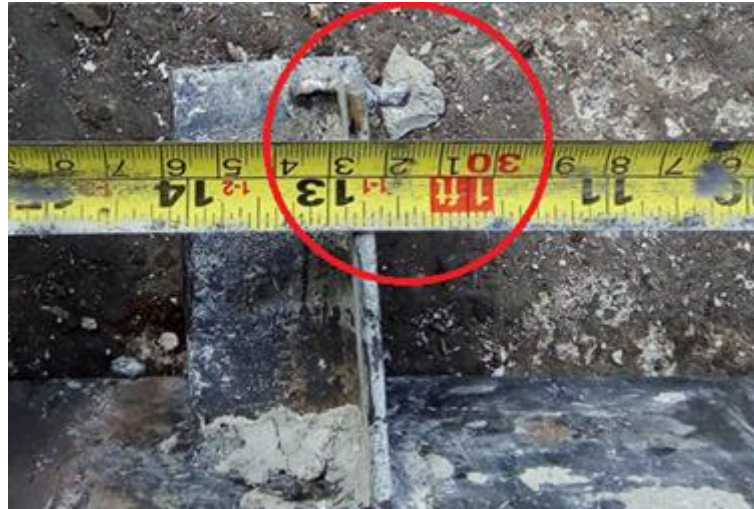
FIGURA 5.45 Longitud superior entre conectores probeta M4-280-90-2.
