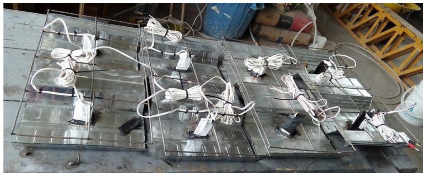
FIGURA 4.40 Probetas instaladas con los strain gauges.
