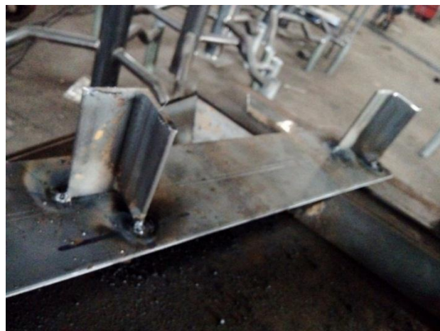
FIGURA 4.11 Punteado de fijación suelda 60/11.
