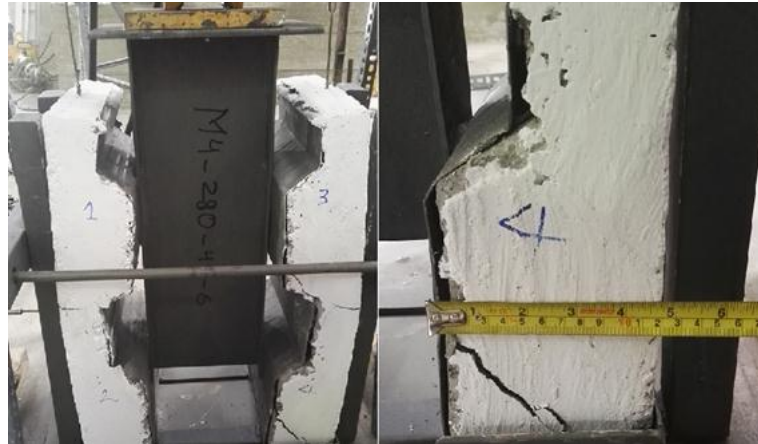
FIGURA 5.2 Fallas probeta de prueba M4-280-45-6.
