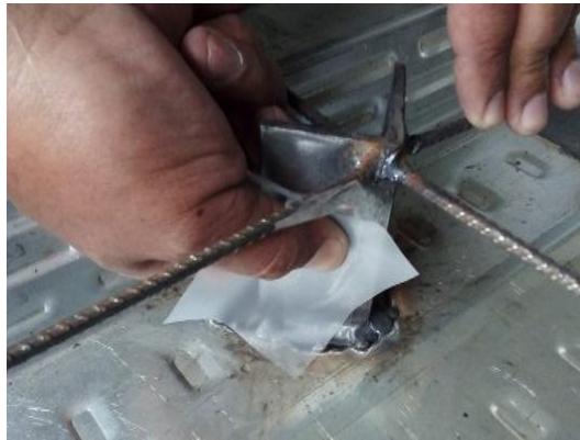
FIGURA 4.33 Uso de teflón en strain gauges.
