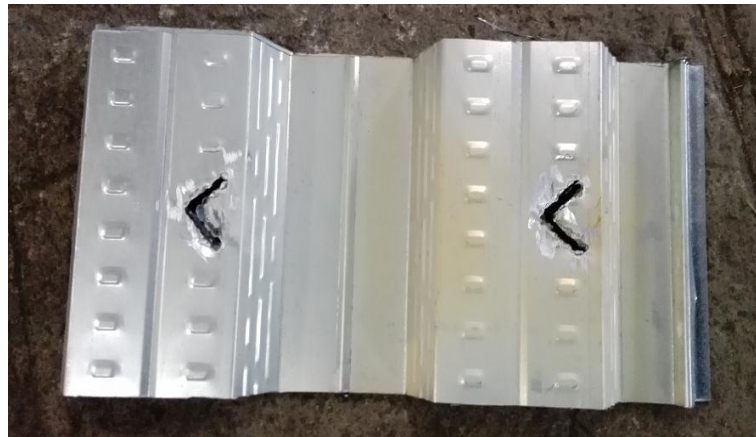
FIGURA 4.10 Perforación lámina deck.
