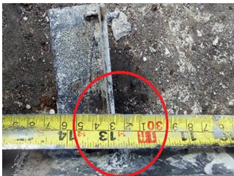
FIGURA 5.44 Longitud inferior entre conectores probeta M4-280-90-2.
