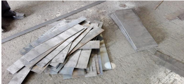
FIGURA 4.2 Corte de láminas para los patines y el alma.
