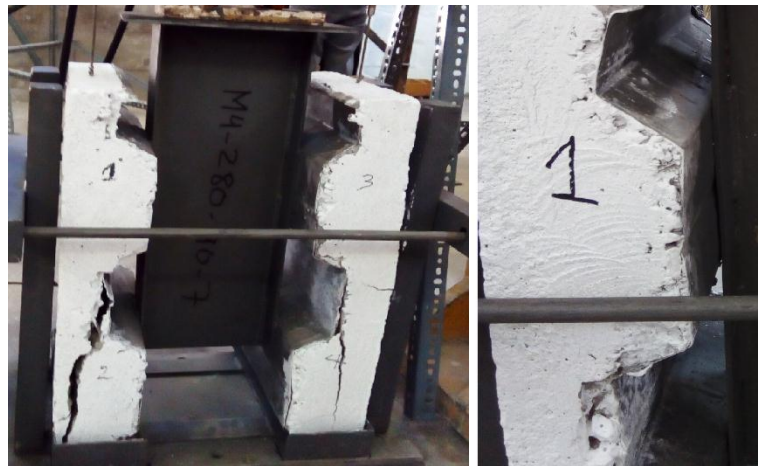
FIGURA 5.3 Fallas probeta de prueba M4-280-90-7.
