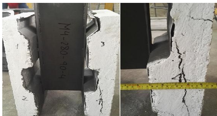
FIGURA 5.4 Fallas probeta de prueba M4-280-90-4.
