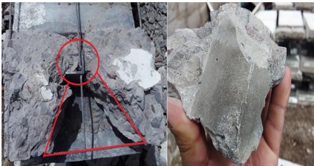
FIGURA 5.43 Falla del hormigón probeta M4-280-90-2.
