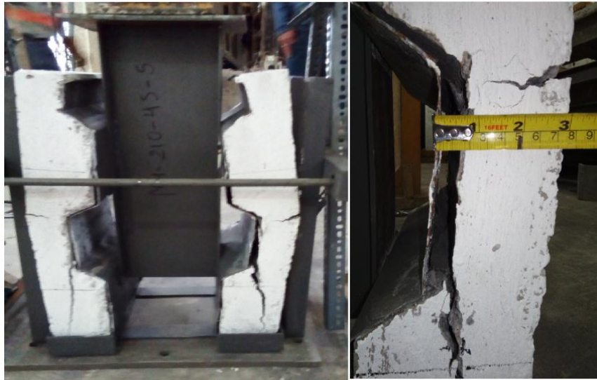
FIGURA 5.6 Fallas probeta de prueba M4-280-90-4.
