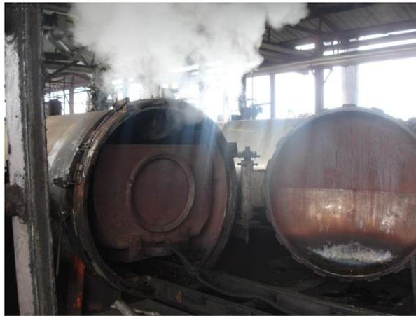
Figura 21. Autoclave y vagoneta.
