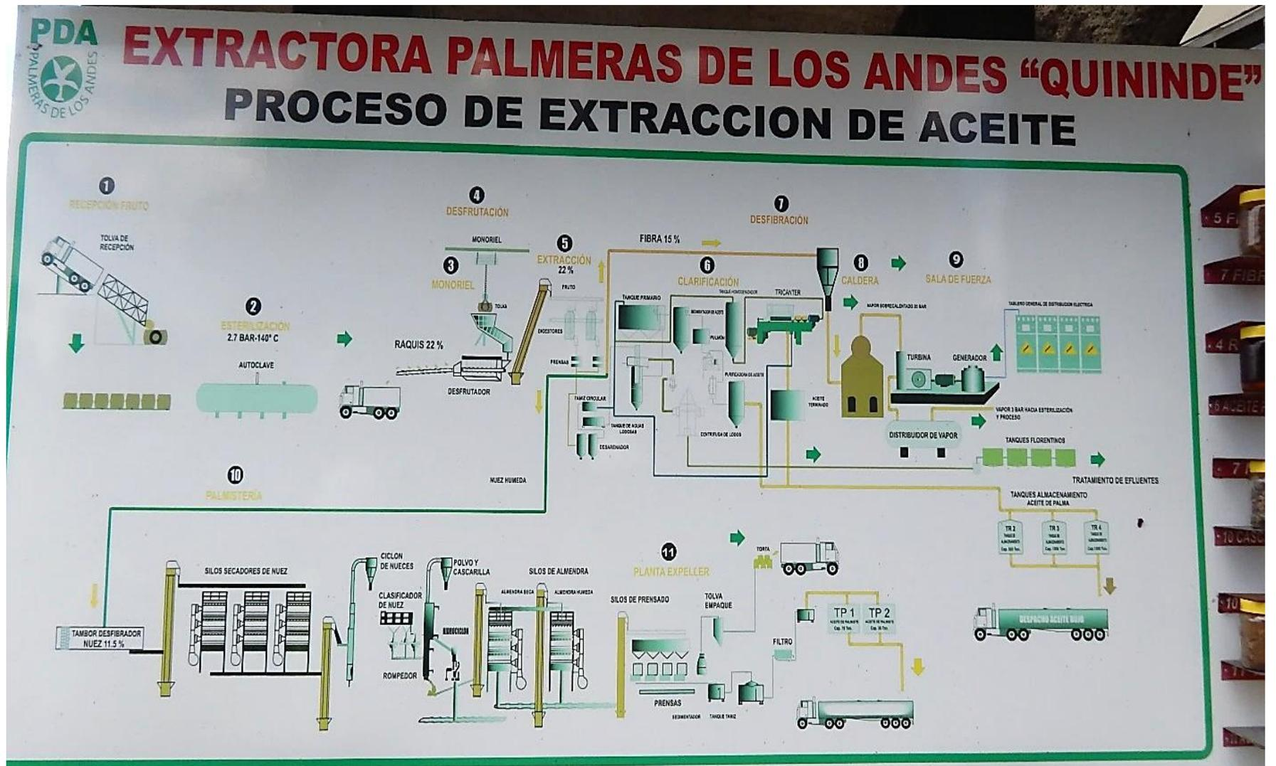
Figura 17. Esquema del proceso de extracción de aceite de palma.
