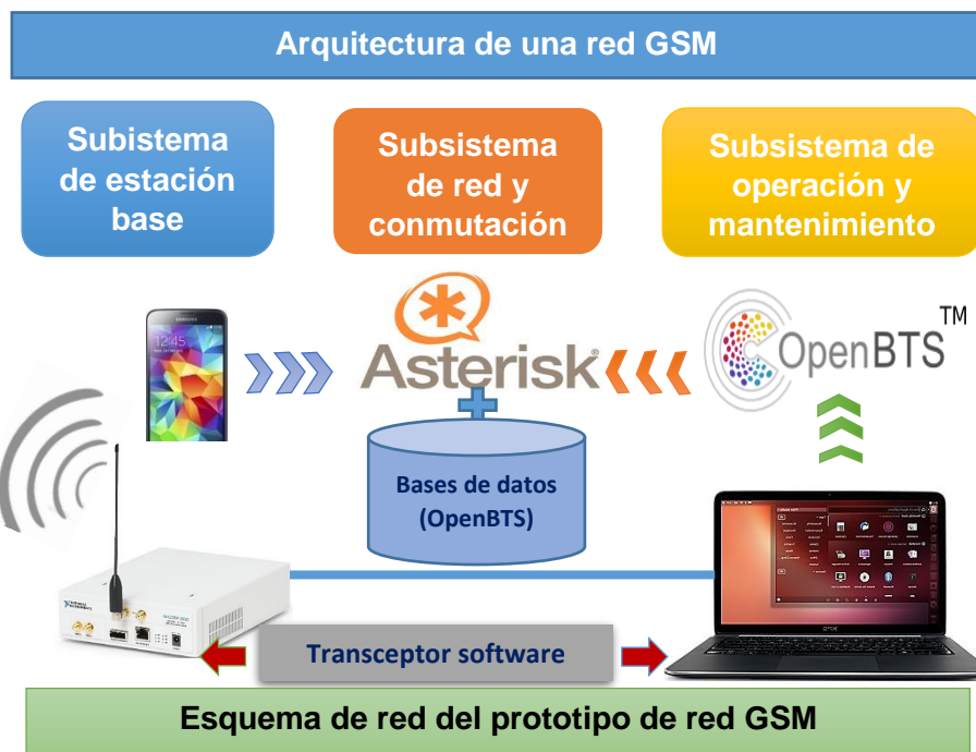
Figura 2. 2 Comparación de la red GSM tradicional con OpenBTS
