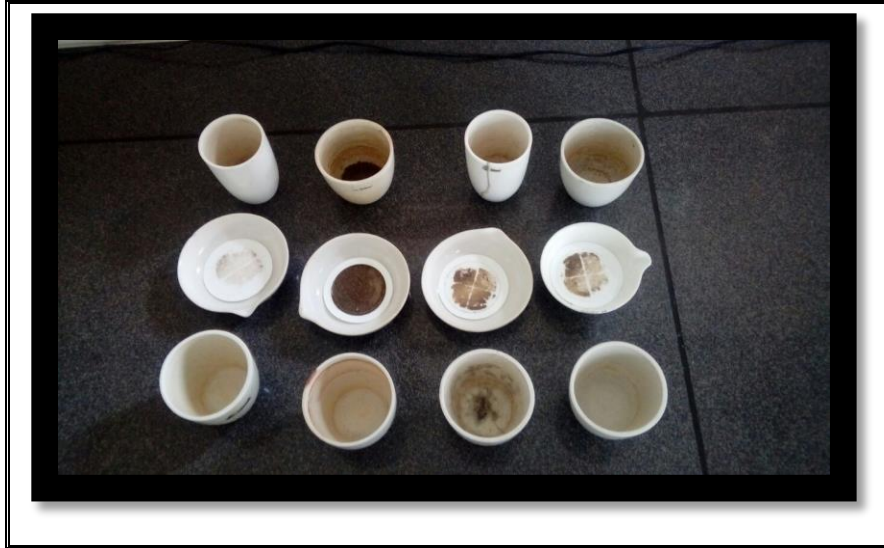
FIGURA 10 SÓLIDOS TOTALES SECADOS A 103-105 ° C MÉTODO APHA 2540 B
