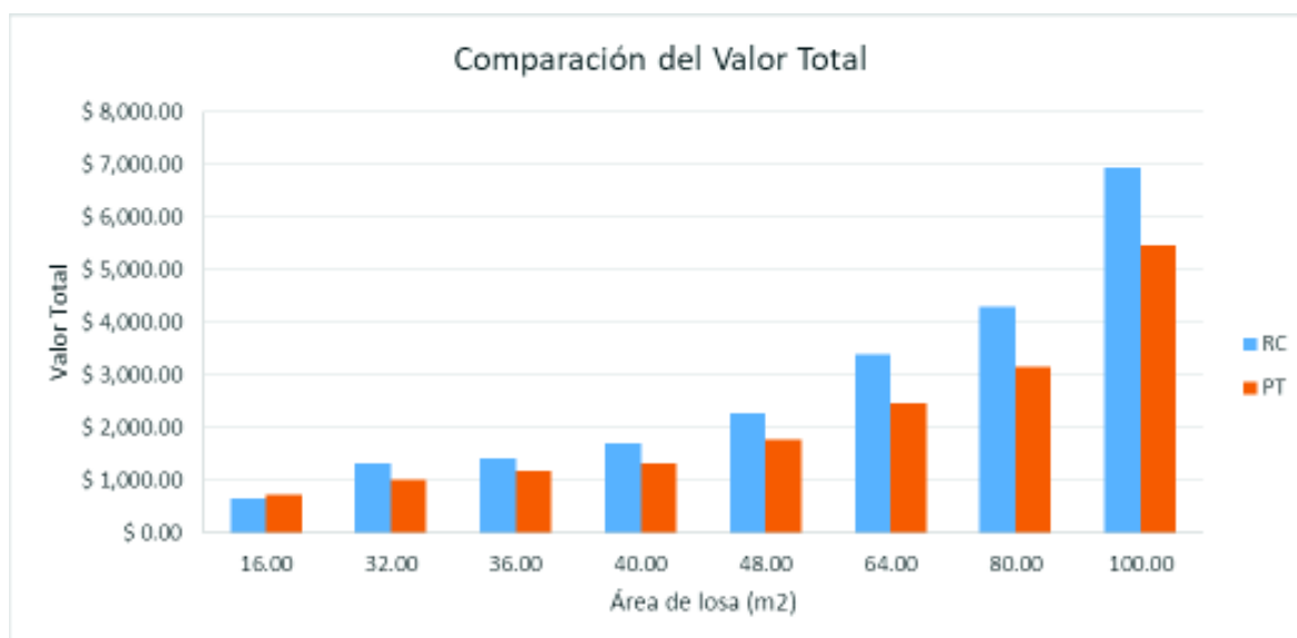
Figura 4. 4 Comparación en costos directos de losas de hormigón armado y losas de hormigón postensado.
