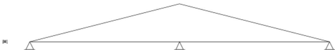
Figura 2. 18 Momento generado por la reacción a la tensión introducida.
