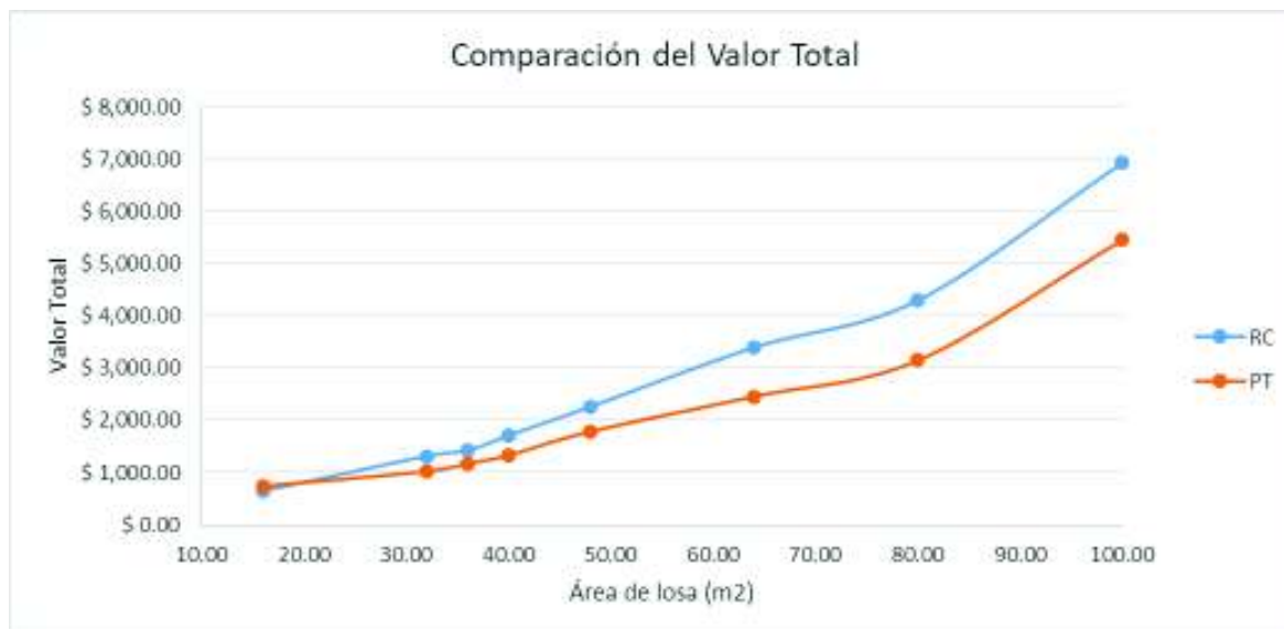
Figura 4. 3 Tendencia de costo de losas macizas aisladas de hormigón armado y de hormigón postensado
