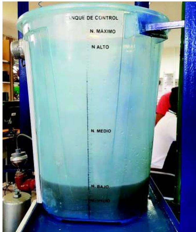
Figura F2.9 – Niveles de control del sistema de nivel
