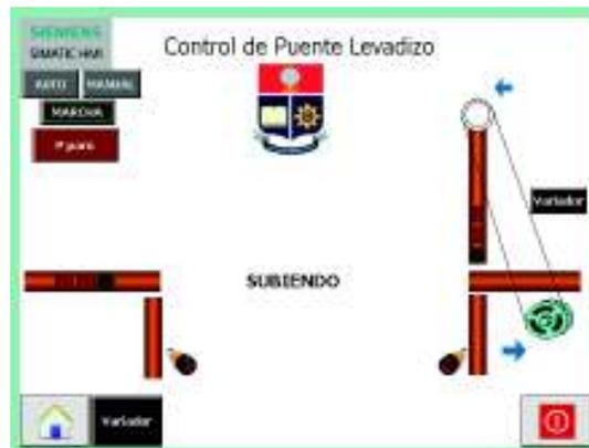
Figura 3.71 – HMI del modo de operación OFF en proceso
