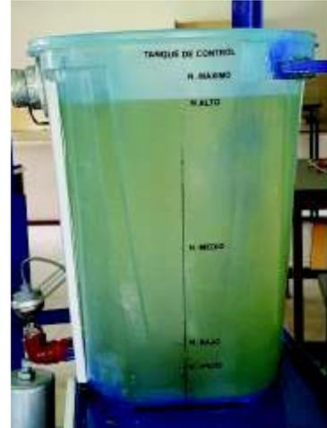
Figura 3.79 – Modo ON: activación del nivel alto del tanque de control
