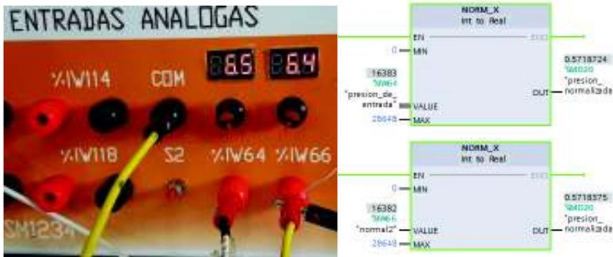
Figura 3.69 – Señal de entrada analógica por señal externa
