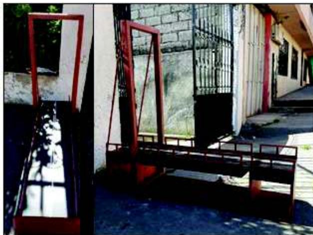
Figura 3.35 – Estructura base del Puente de Báscula
