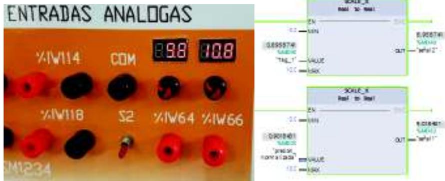
Figura 3.68 – Señal de entrada analógica por potenciómetro
