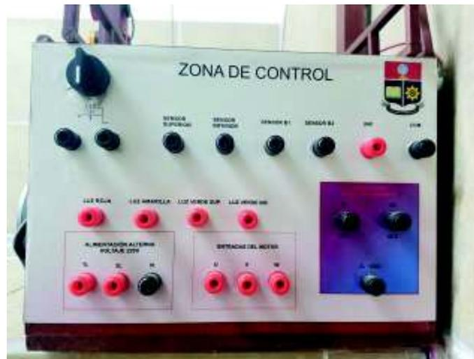
Figura 3.45 – Borneras de conexión
