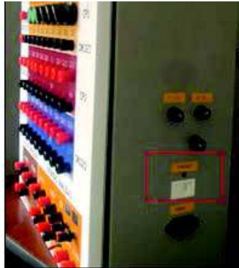
Figura 3.30 – Ubicación del puerto de comunicación Ethernet
