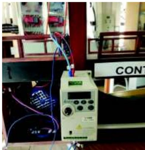
Figura 3.42 – Posicionamiento del variador de frecuencia
