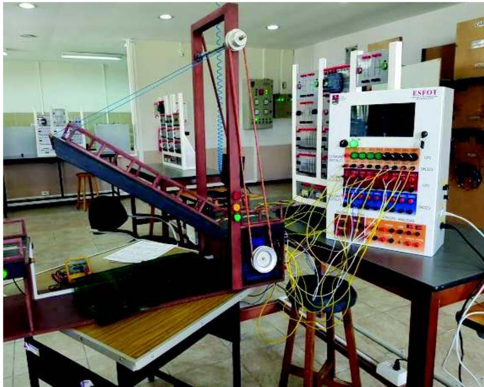
Figura 3.75 – Conexión del puente levadizo y el PLC
