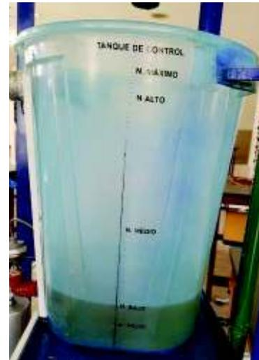
Figura 3.81 – Modo ON: activación del nivel bajo del tanque de control
