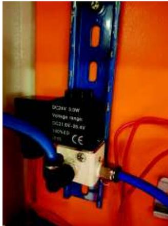
Figura 3.56 – Posicionamiento de la electroválvula
