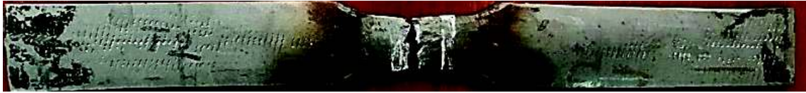
Figura 3.3. Fractura de la probeta T-2 (cara frontal).
