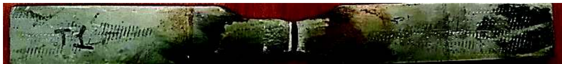
Figura 3.1. Fractura de la probeta T-1 (cara frontal).
