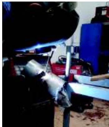
Figura 2.8. Soldadura de pases de relleno.
