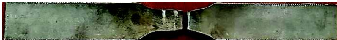
Figura 3.2. Fractura de la probeta T-1 (cara posterior).
