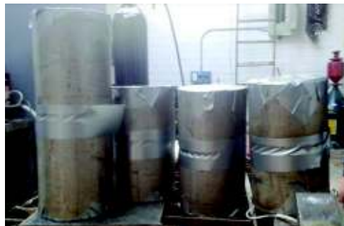
Figura 2.5. Sellado y compactado del material base.
