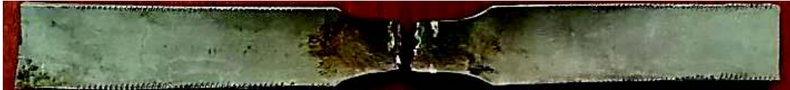
Figura 3.4. Fractura de la probeta T-2 (cara posterior).
