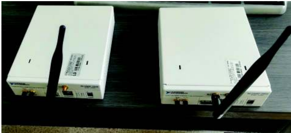
Figura 3. 48 Equipos USRP conectados a las antenas VERT900
