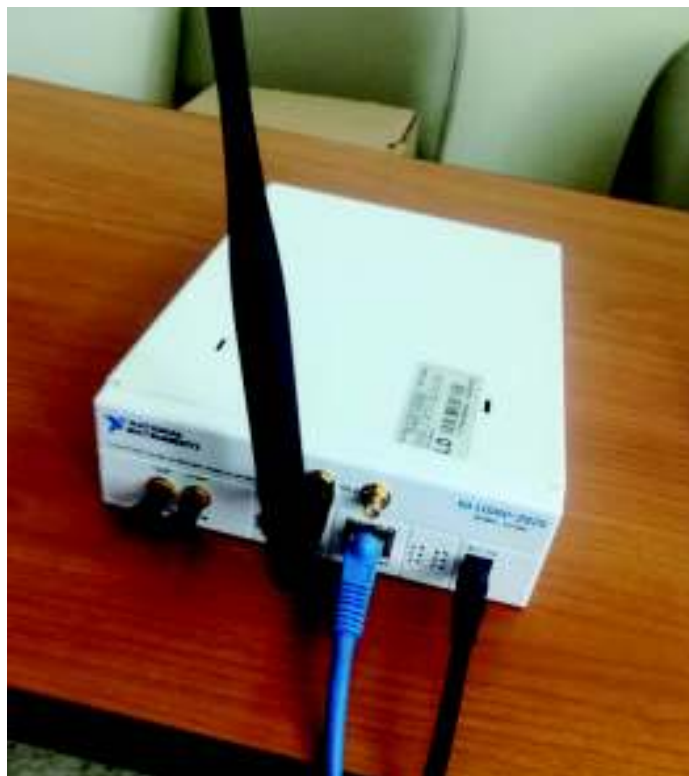
Figura 2. 68 Antena VERT 900 conectada al equipo
