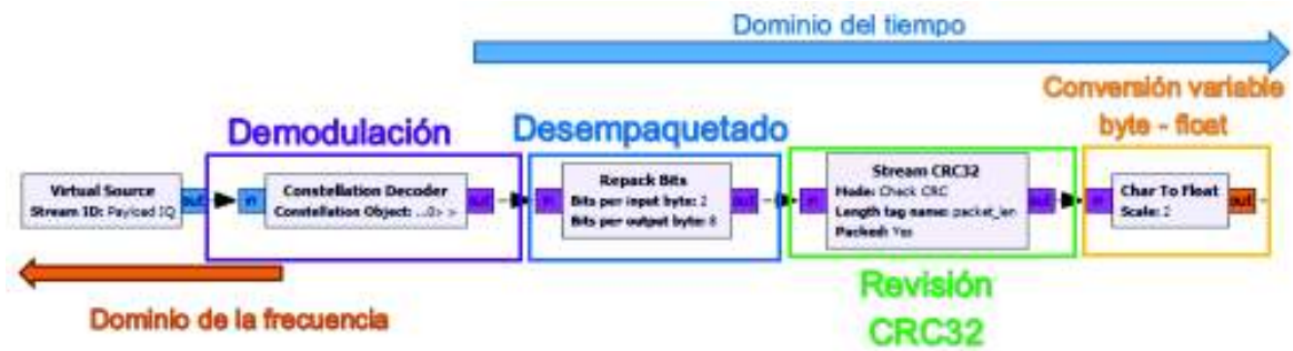
Figura 2. 52 Demodulación, desempaquetado y verificación de CRC en la carga útil.
