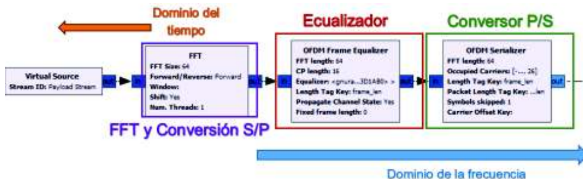
Figura 2. 48 Bloques procesamiento OFDM de la Carga Útil
