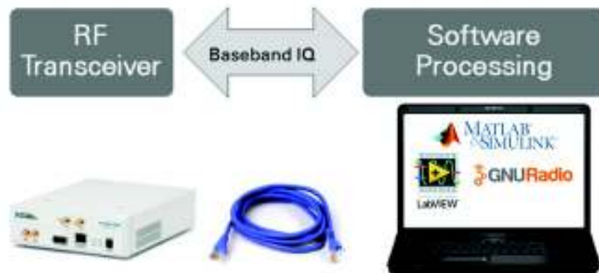
Figura 1. 10 Descripción simplificada de una configuración de SDR construida alrededor de un NI USRP.
