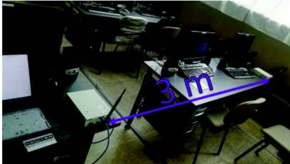
Figura 3. 55 Sistema transmisor - receptor OFDM a 3m de distancia
