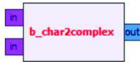
Figura 1. 17 Bloque Conversor de variable caracteres a complejos [24].
