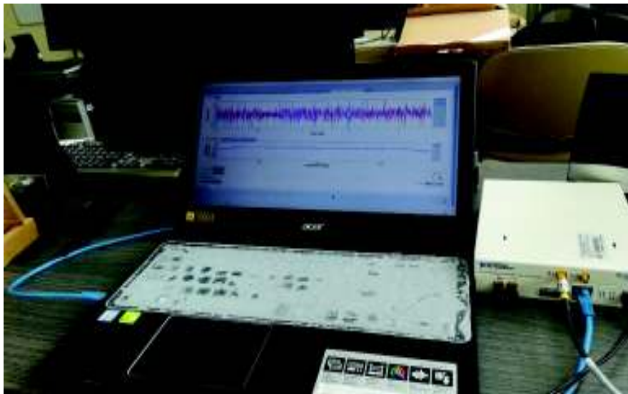
Figura 3. 52 Estación 1, Laptop y equipo USRP como transmisor
