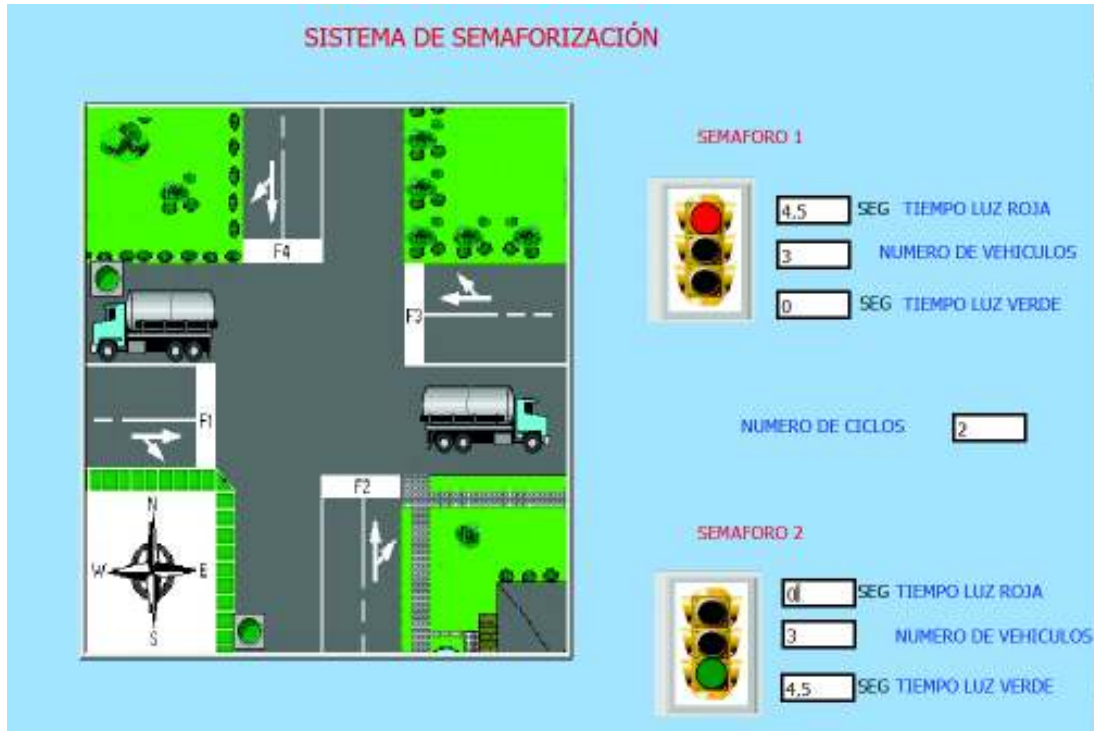
Figura 3.46: HMI del sistema de semaforización.
