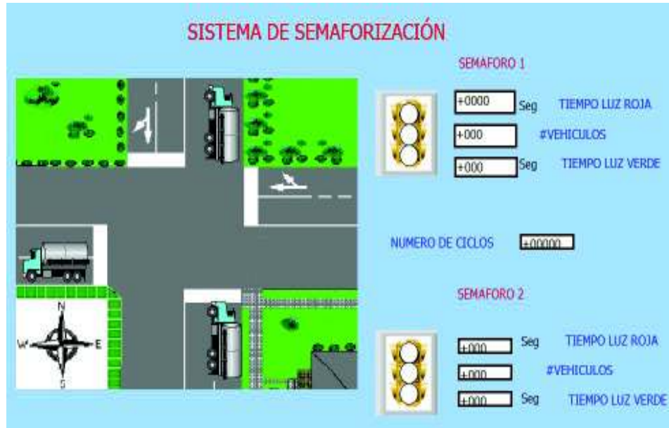
Figura 3.34: Interfaz Humano Máquina (HMI) del sistema de semaforización.
