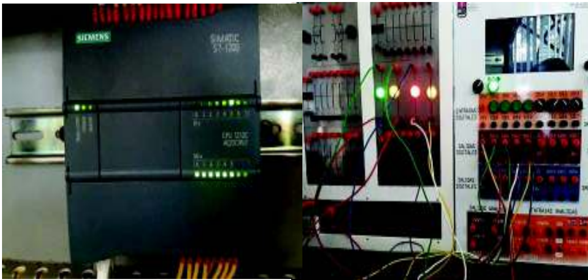
Figura 3.37: Funcionamiento de salidas digitales.
