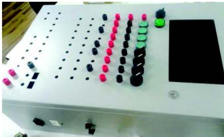
Figura 3.23: Montaje del módulo PLC.
