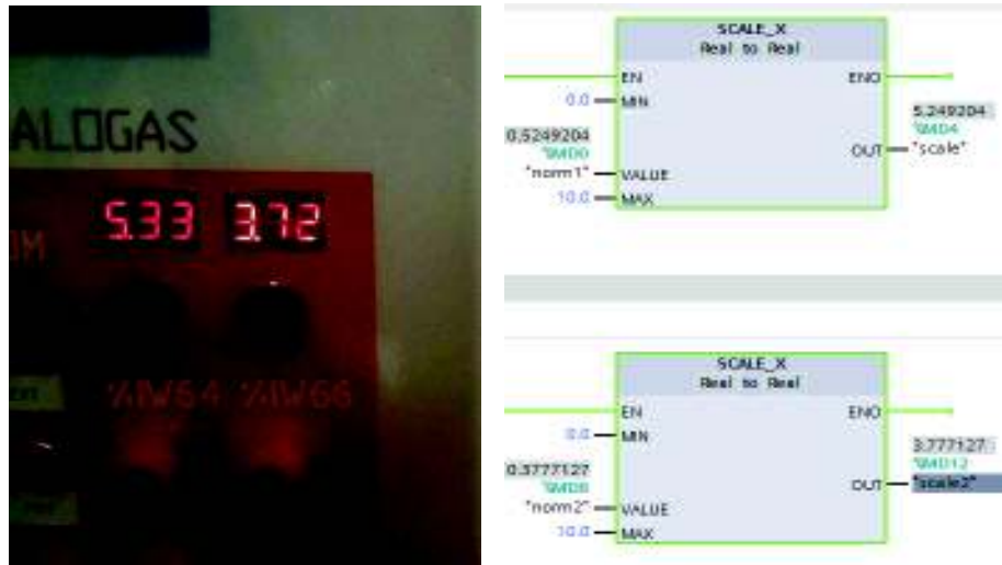
Figura 3.38: Funcionamiento entrada análoga mediante potenciómetros.
