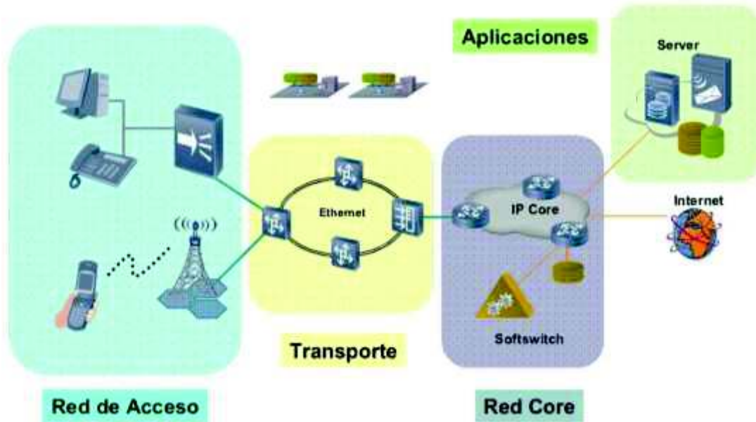
Figura 1.1. Estructura General de una Red de Telecomunicaciones. [2]
