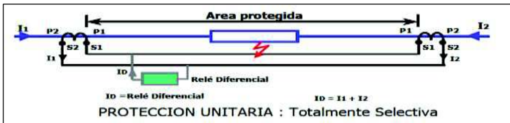
Figura 1.4.2 Ejemplo de la Protección Unitaria
