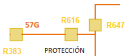
Figura 4.69. Distribución de reconectores a coordinar del ramal 57 G
