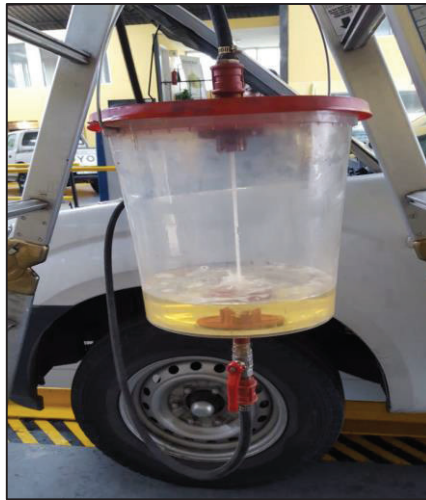
Figura 2. 13. Instalación del depósito externo de combustible.
