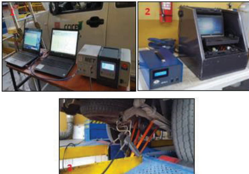
Figura 2. 10. Instalación de los analizadores de gases, vista lateral y posterior.
