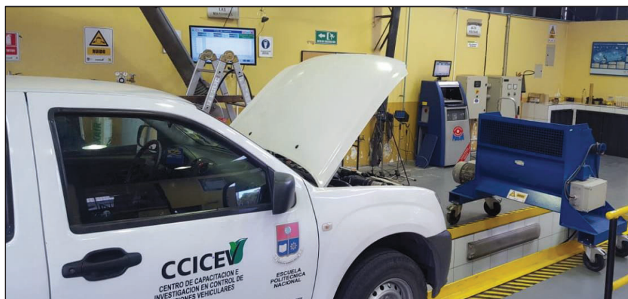
Figura 2. 12. Posicionamiento del ventilador.
