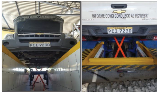
Figura 2. 9. Posicionamiento y fijación del vehículo de prueba sobre el dinamómetro, vista frontal y posterior.
