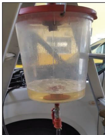
Figura 2. 5. Tanque externo, medidor de consumo de combustible.
