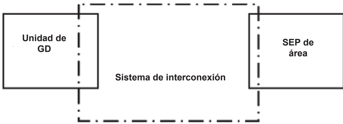
Figura 4.2 Esquema de interconexión. [18]
