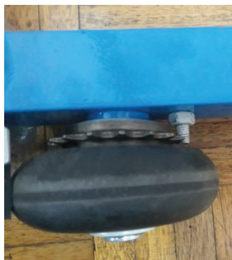
Figura 3.6. Sistema de anti retroceso, compuesto por un free wheel (bronce) y un perno (gris) como traba.
