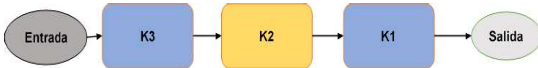
Figura 2.6 Diagrama de bloques del proceso de Descriptación TripleDES. [16]
