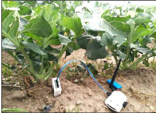
**Figura 3.7.** Mota ubicada en el cultivo conectada al sensor
