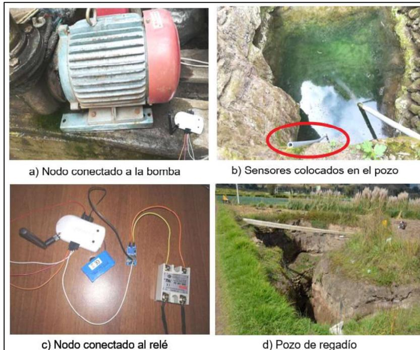
**Figura 3.8.** Nodo actuador en el pozo
