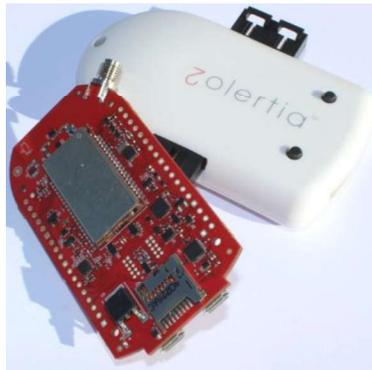
**Figura 1.6.** Plataforma Zolertia RE-Mote [22]
