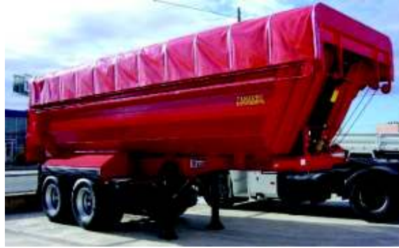
Figura 1.9. Bañera fabricada en acero anti abrasivo. Fuente: (Industria Zamarbú S.L, 2018).
