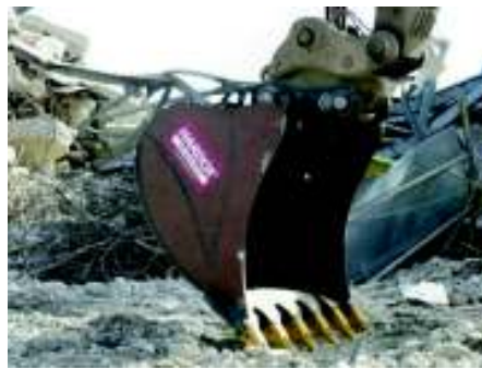
Figura 1.10. Cucharon de excavadora fabricado de acero anti abrasivo. Fuente: (Project Plant Shop, 2018).
