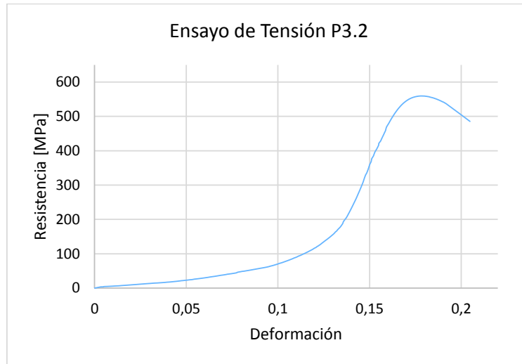
Figura 3.11. Diagrama esfuerzo vs deformación P 3.2. Fuente: (Propia).
