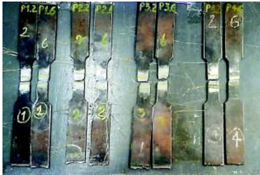
Figura 3.4. Probetas después del ensayo de tracción Fuente: (Propia).
