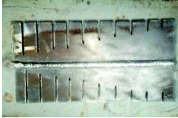
Figura 2.10. Placa después del ensayo Houldcroft. Fuente: (Propia).
