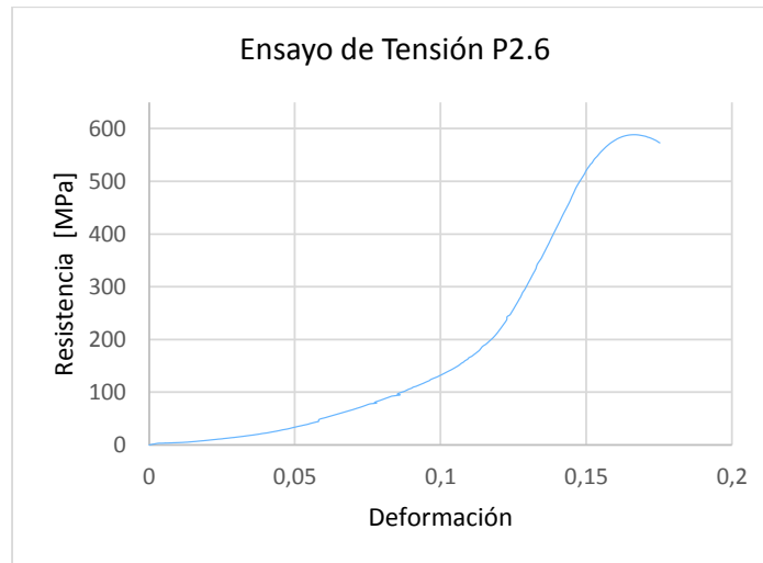
Figura 3.9. Diagrama esfuerzo vs deformación P 2.6. Fuente: (Propia).
