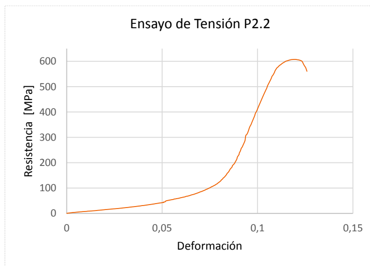
Figura 3.8. Diagrama esfuerzo vs deformación P2.2. Fuente:(Propia).
