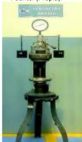
Figura 2.7. Durómetro Brinell LAEV. Fuente: (Propia).
