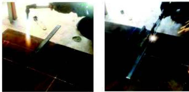
Figura 2.13. Realización del corte de la plancha de acero anti abrasivo grado 450. Fuente: (Propia).
