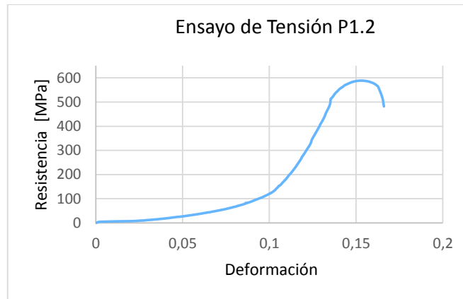
Figura 3.5. Diagrama esfuerzo vs deformación P 1.2. Fuente: (Propia).
