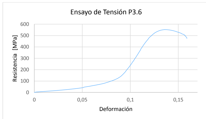
Figura 3.12. Diagrama esfuerzo vs deformación P3.6. Fuente: (Propia).
